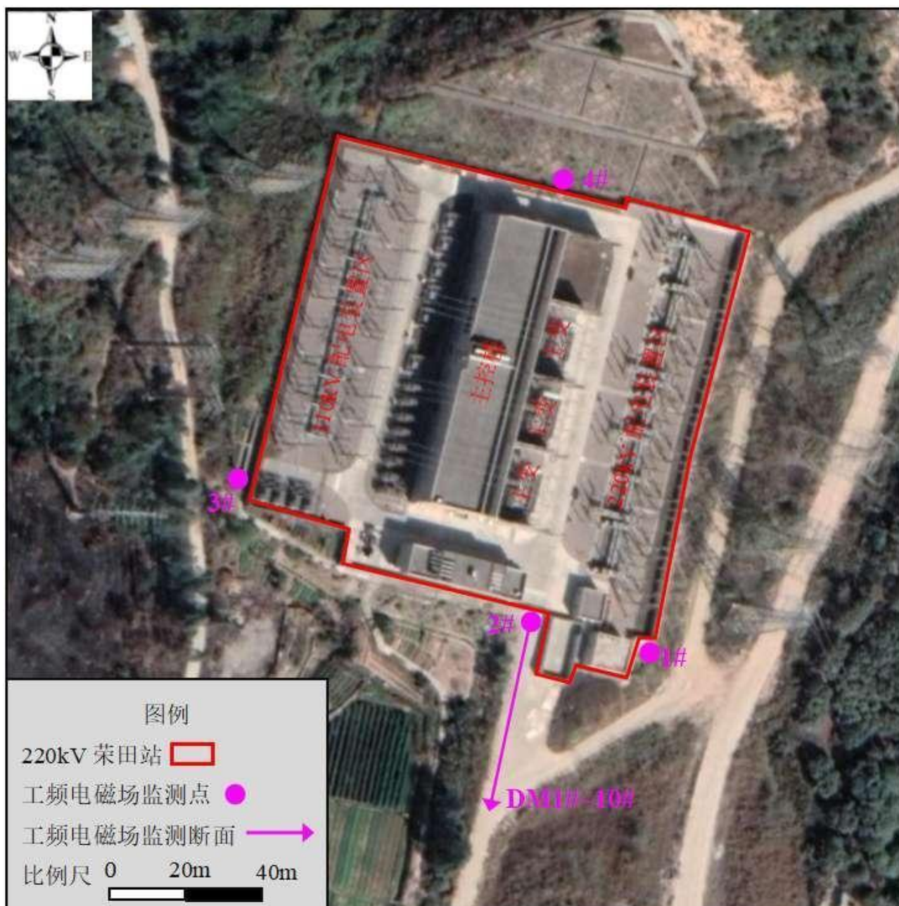
图 9.1-1 220kV 荣田变电站监测布点图
