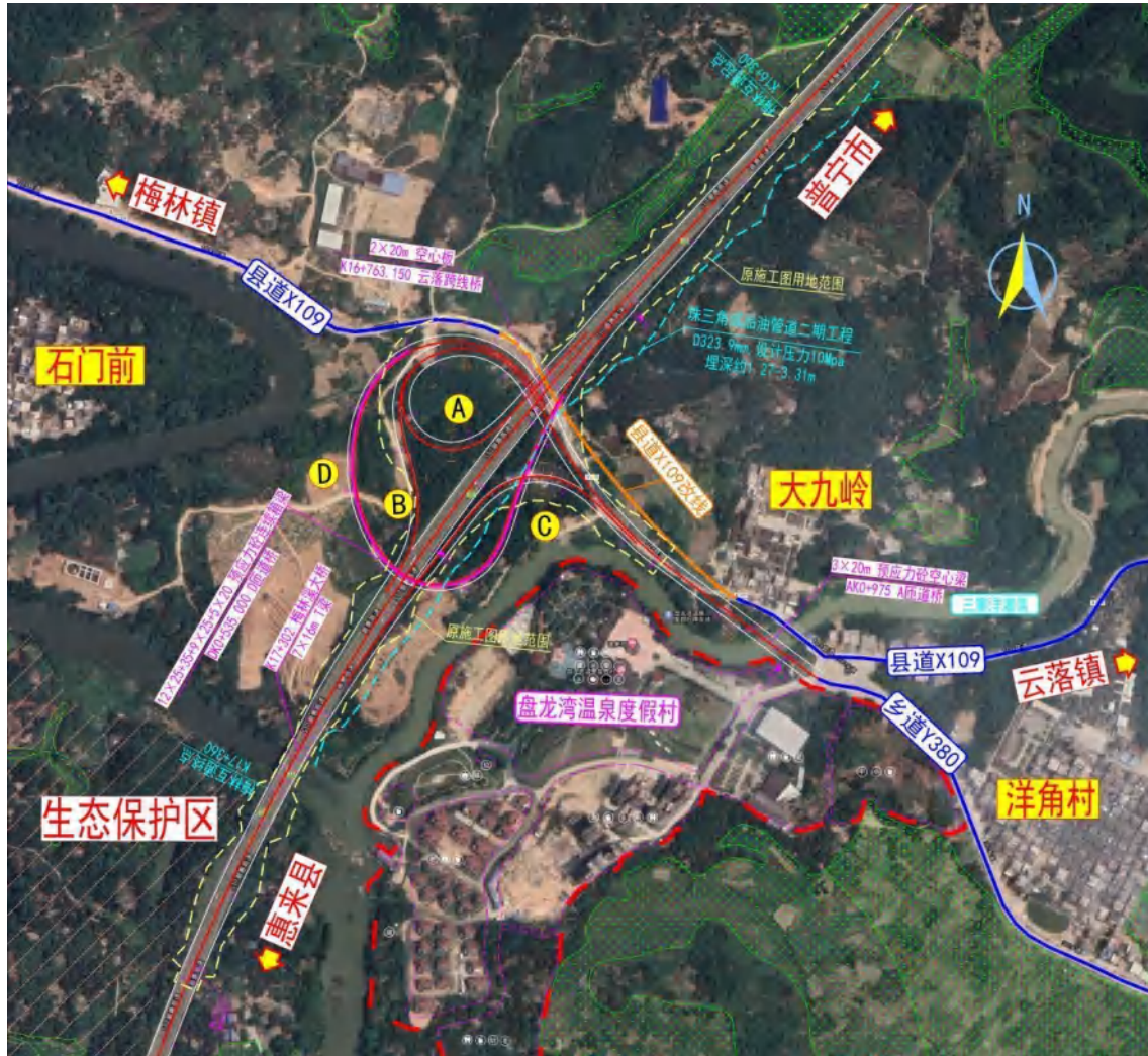
图 2.1-6 工可比选方案二（变异 B 型单喇叭方案）
