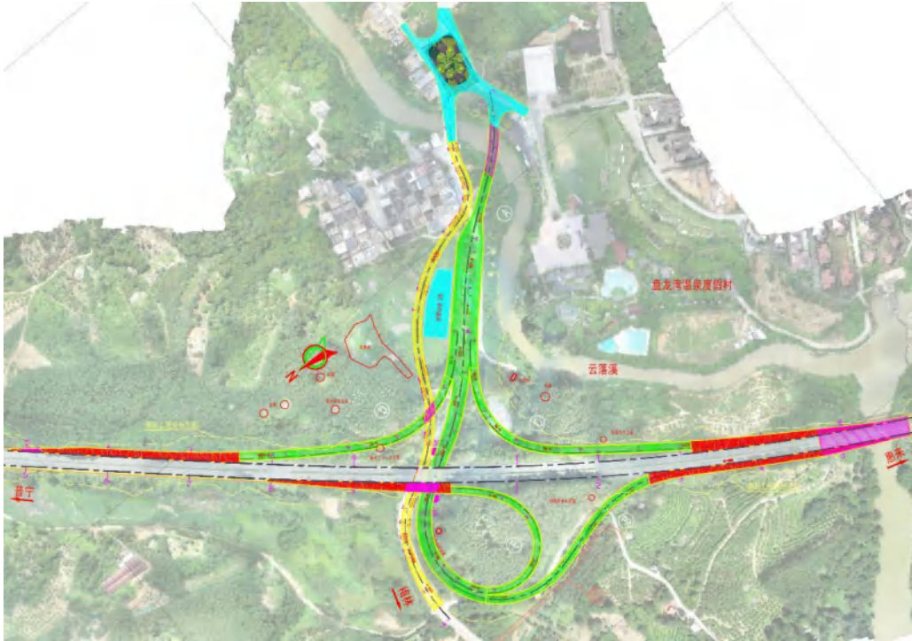
图 2.1-13 方案一平面布置图（平交口位于三寨洋灌渠的东南侧）
