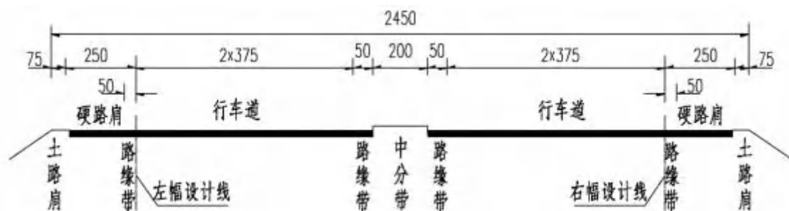
图 2.2-3 既有高度主线路基标准横断面
