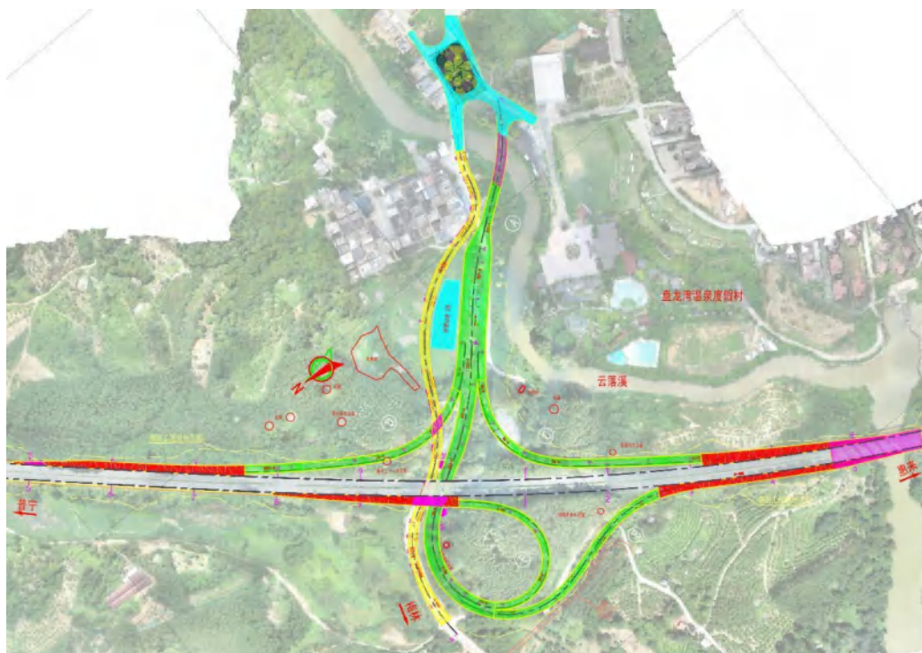
图 2.1-15 B 型单喇叭方案平面布置图（平交口位于三寨洋灌渠的东南侧）
