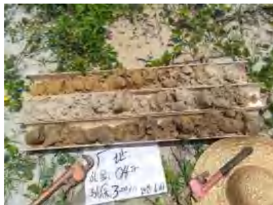
图 3-4 炼化厂区占地范围内柱状样 4#
