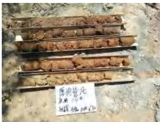
图 3-13 管线沿线柱状样 4#
