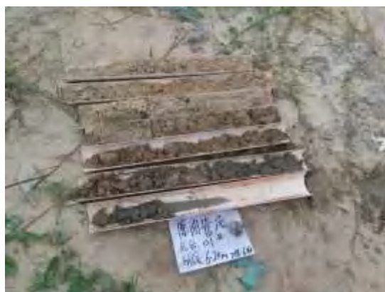
图 3-12 管线沿线柱状样 1#
