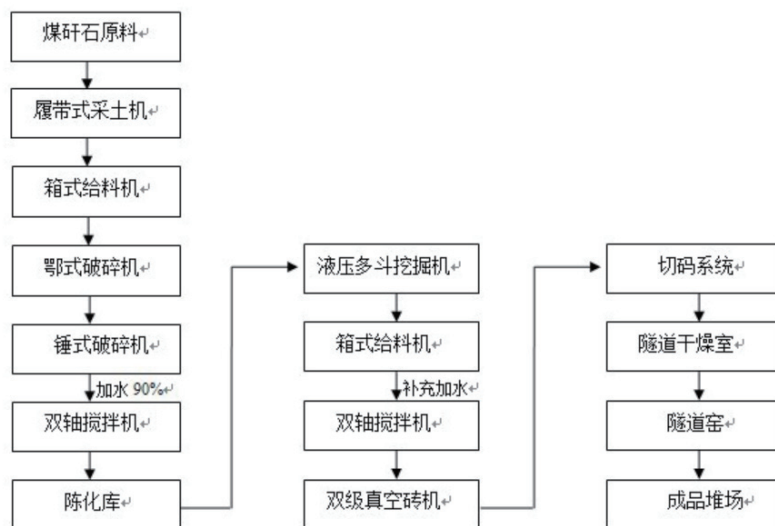
图 5-11 多孔砖生产工艺流程图
