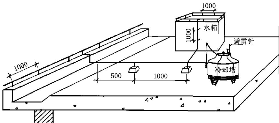
图 36 屋面冷却塔防雷装置施工大样图
