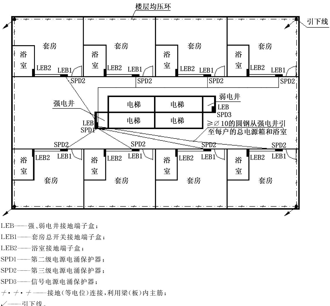
图 41 住宅公寓接地端子 LEB、电源电涌保护器安装示意图
