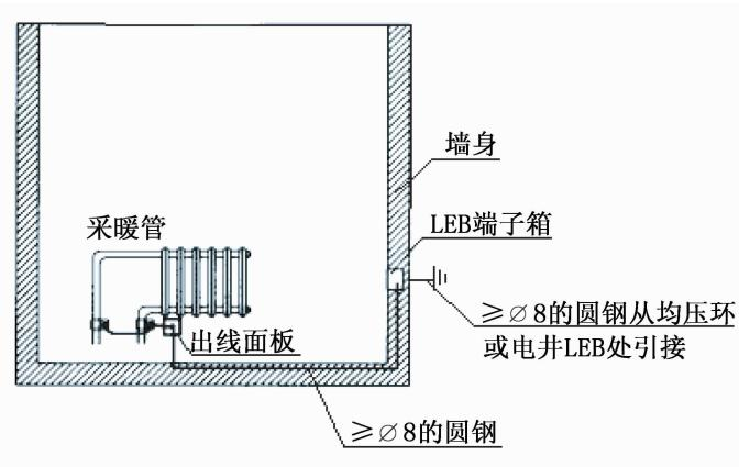
图 38 采暖管接地施工大样图
