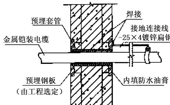
图 34 穿越防雷区电力电缆(电力、信号)等电位连接图
