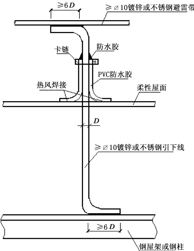
图 31 柔性屋面引下线安装大样图
