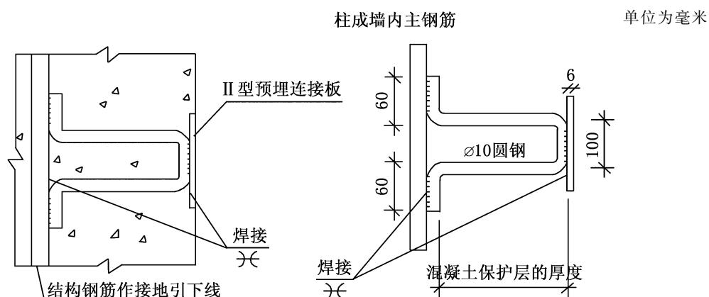
图 18 预埋接地端子安装大样图
