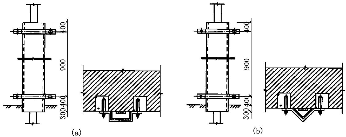
图 25 人工引下线保护施工大样图
