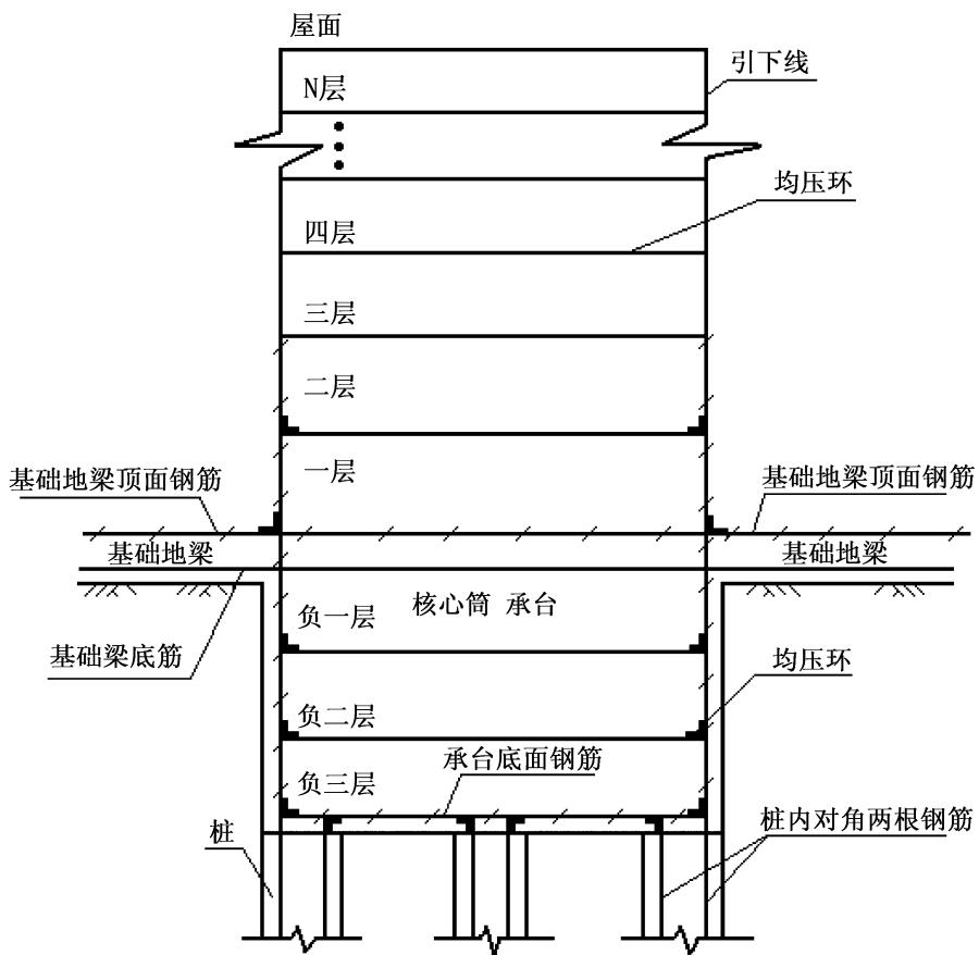
图 23 核心筒防雷接地点立面详图
