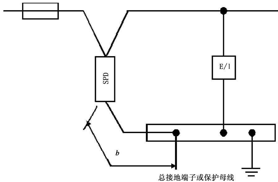
图 68 SPD 安装在或靠近电气装置电源进线端的示例
