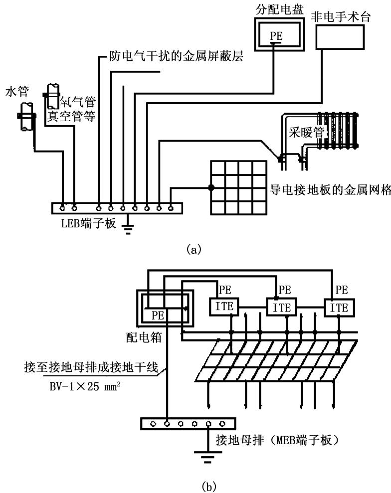
图 49 辅助等电位连接示意图
