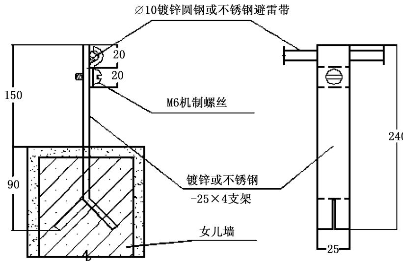
图33 避雷带支持卡施工大样图
