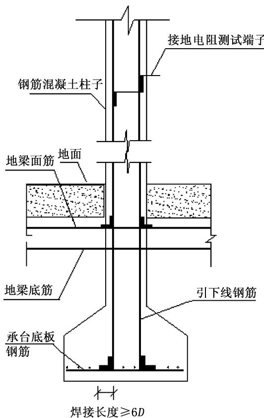
图 14 承台、地梁与引下线连接大样图
