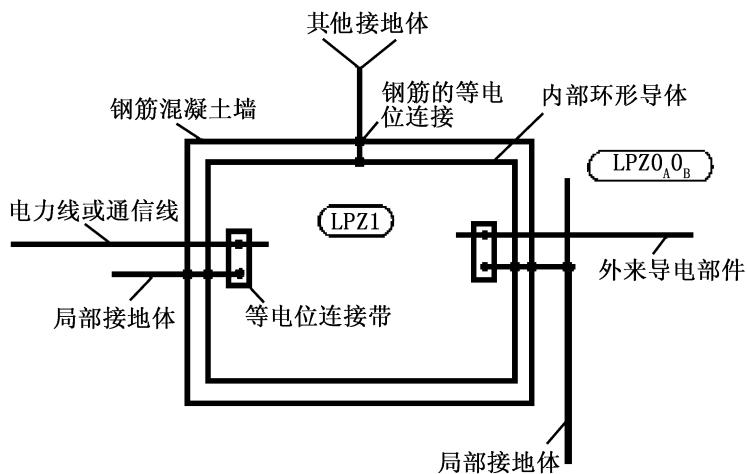
图 62 外来导电部件在地面上从多点进入建筑物的情况下,采用内部环形导体实现等电位连接
