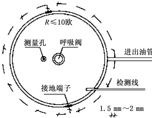
图 74 油罐防雷装置安装示意图
