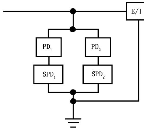
图 71 供电连续性和保护连续性的结合
