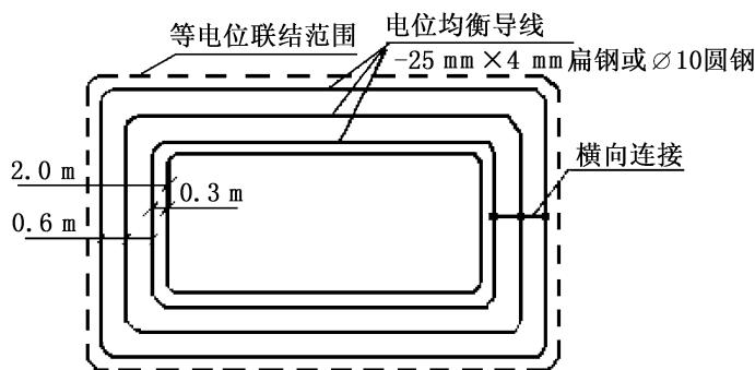
图 39 喷水池等电位连接施工大样图
