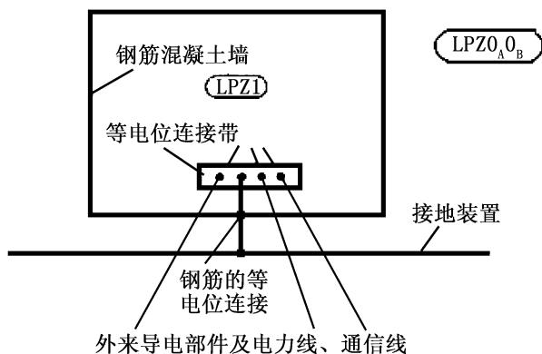
图 64 外来导电部件单点进入建筑物情况下的等电位连接
