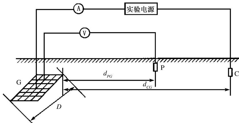
图 E.1 电流-电压表三极法示意图
