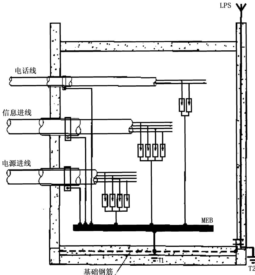
图 66 防雷装置等电位连接安装示意图
