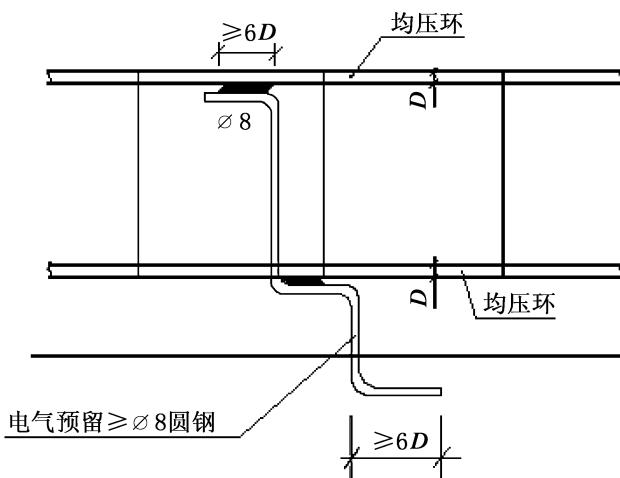
图 27 均压环预留钢筋连接施工大样图
