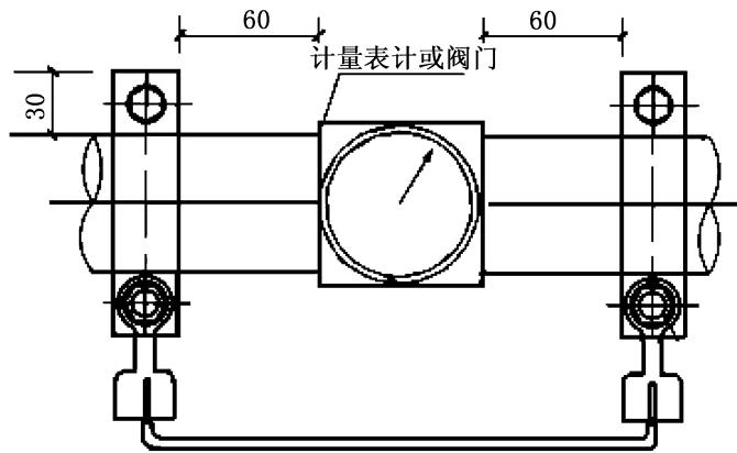
图 50 计量表等电位连接大样图
