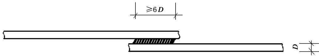
图 20 钢筋直接搭接的做法
