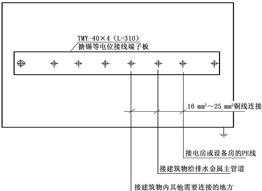
图 46 MEB 箱内接线示意图
