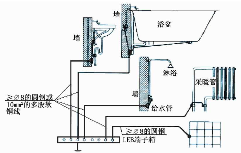
图 37 卫生间等电位连接施工大样图
