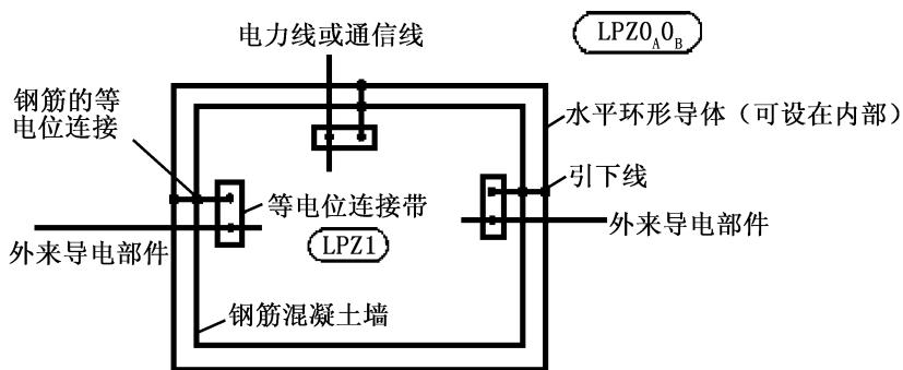
图 63 外来导电部件空中多点进入建筑物的情况下的等电位连接
