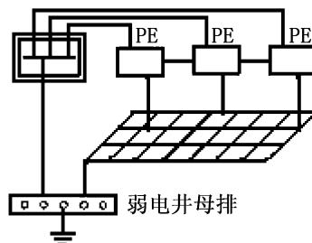
图 52 M型接地方式
