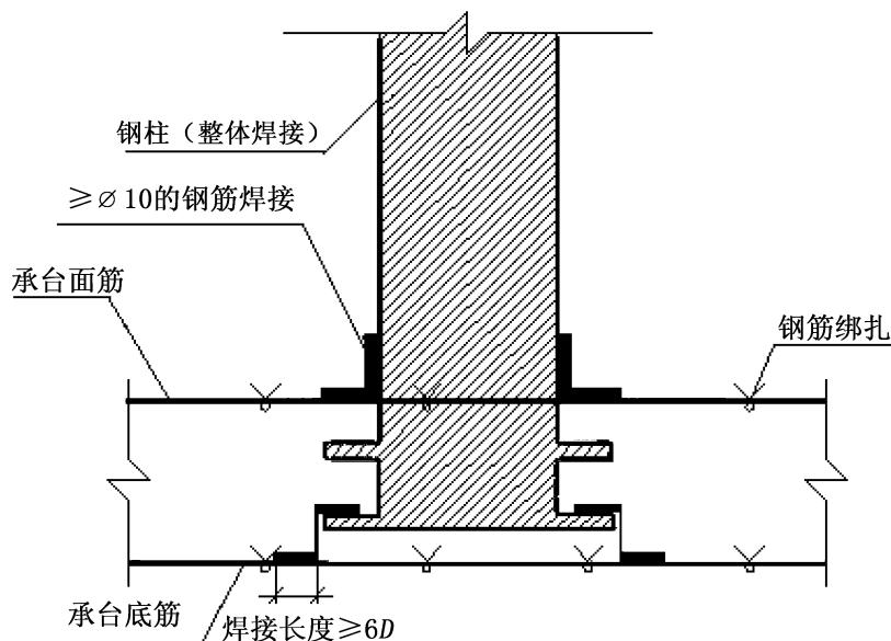
图 13 钢柱与承台钢筋体的连接大样图
