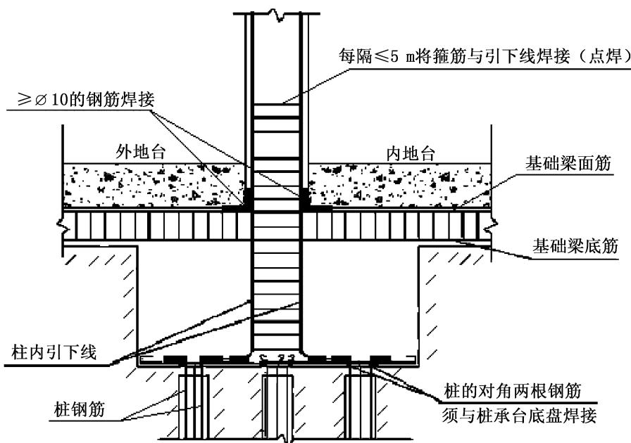
图 11 基础接地装置施工大样图
