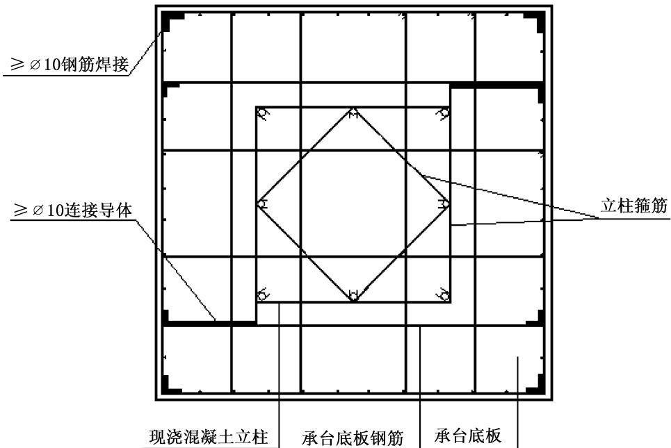
图 8 承台与立柱钢筋焊接施工大样图
