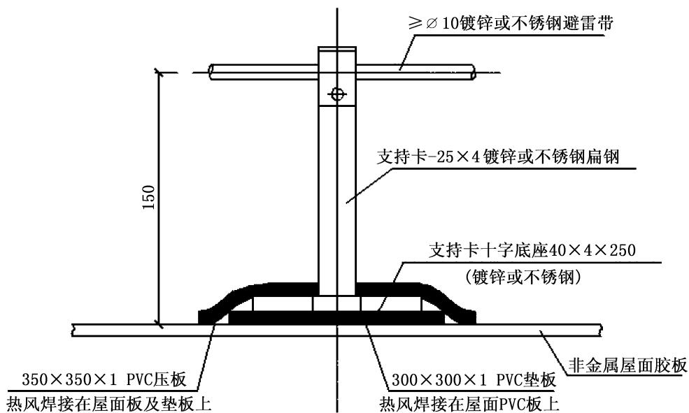
图 30 柔性屋面支持卡安装大样图
