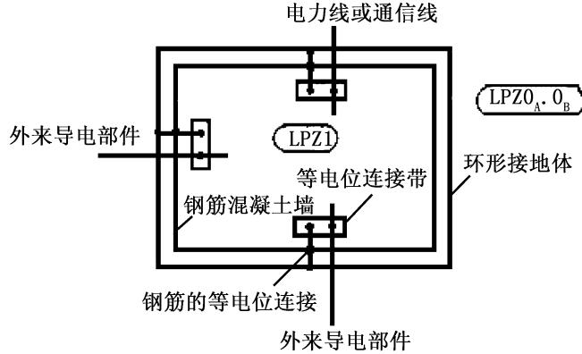
图 61 外来导电部件在地面上从多点进入建筑物的情况下,采用环形接地装置实现等电位连接
