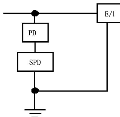
PD——电涌保护器的保护电器；
