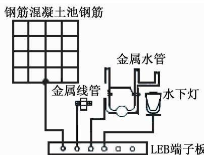
图 40 喷水池等电位连接施工大样图
