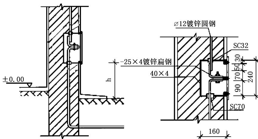
图 17 暗装接地端子大样图
