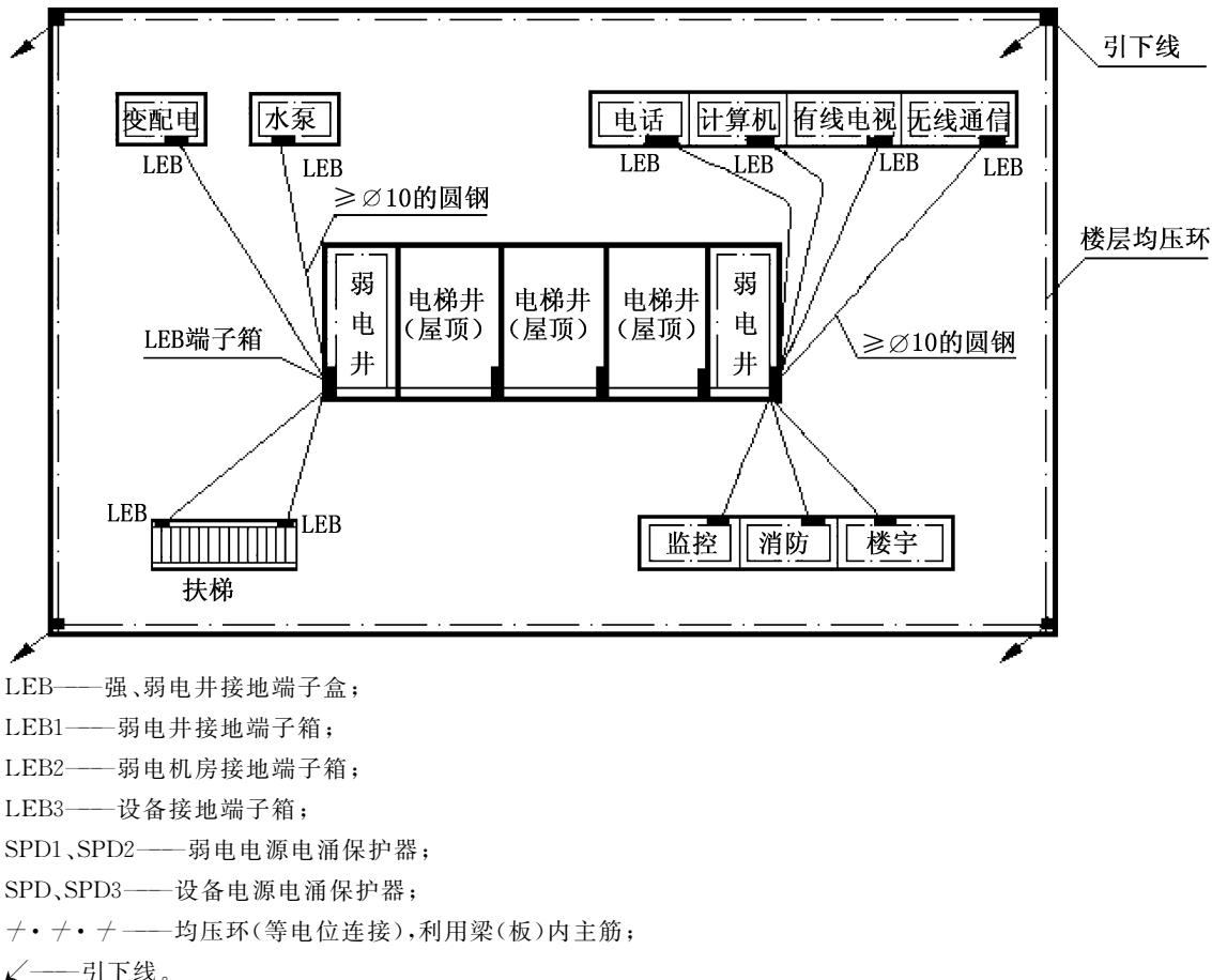
图 42 设备机房接地平面示意图
