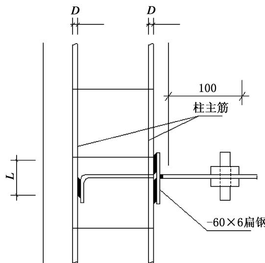
图 35 接地引出线施工大样图
