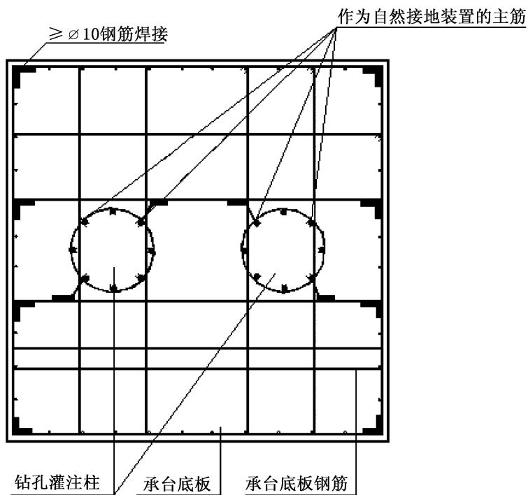
图 9 承台与桩基钢筋的焊接施工大样图
