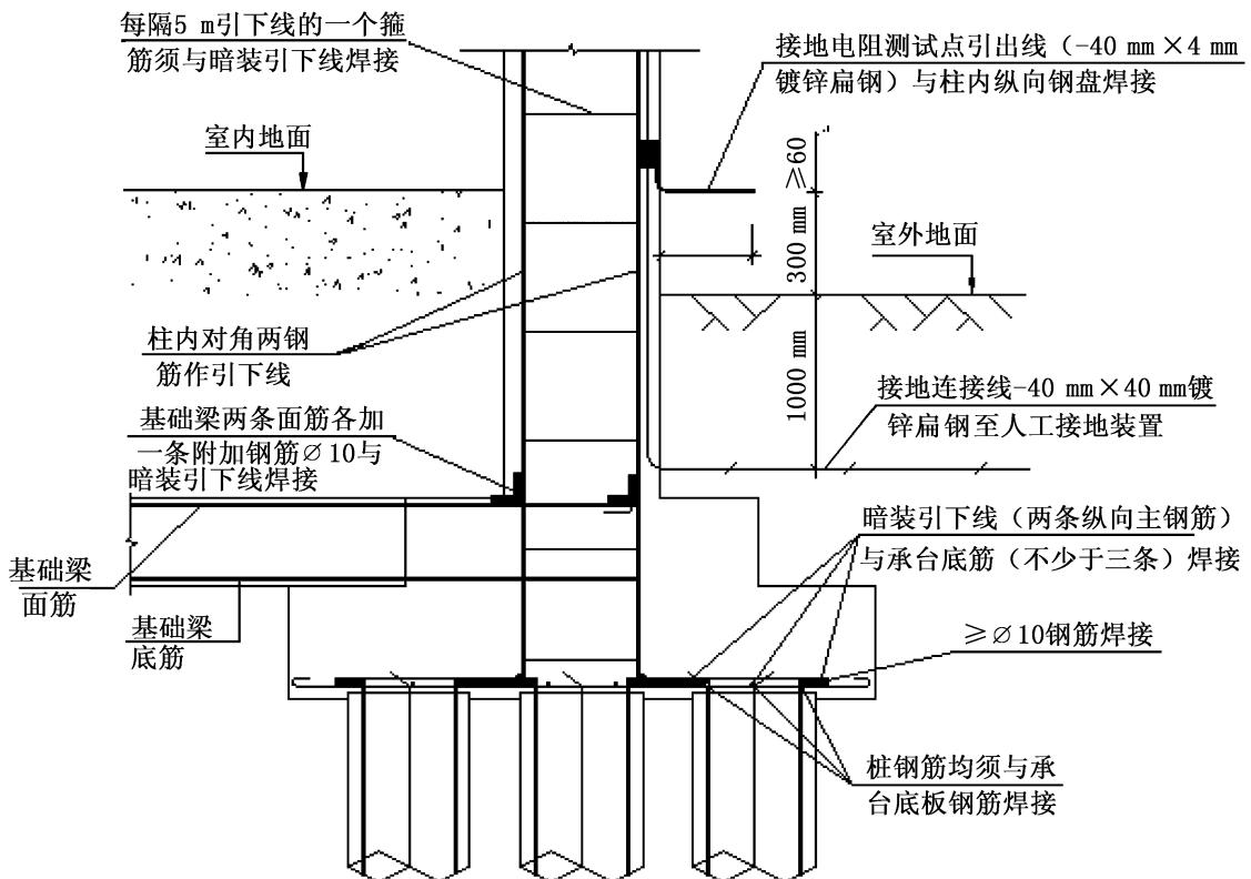
图 10 静压式锥击桩防雷施工大样图
