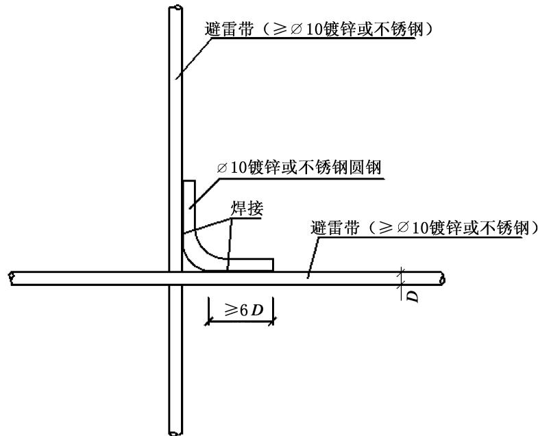
图 29 柔性屋面避雷带连接大样图
