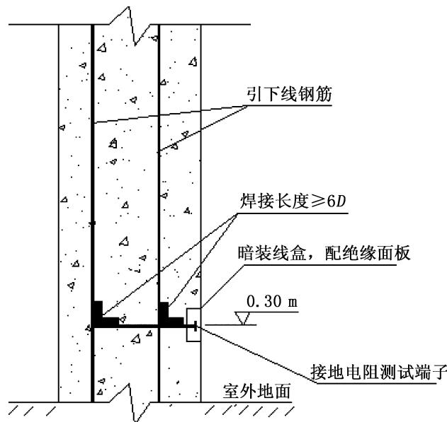
图 15 接地电阻测试端子施工大样图
