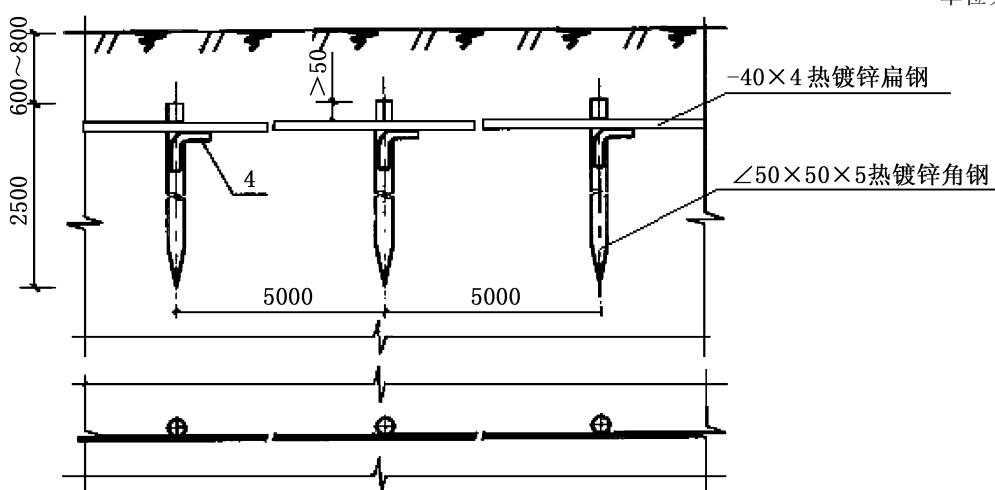
图 19 人工接地装置安装示意图
