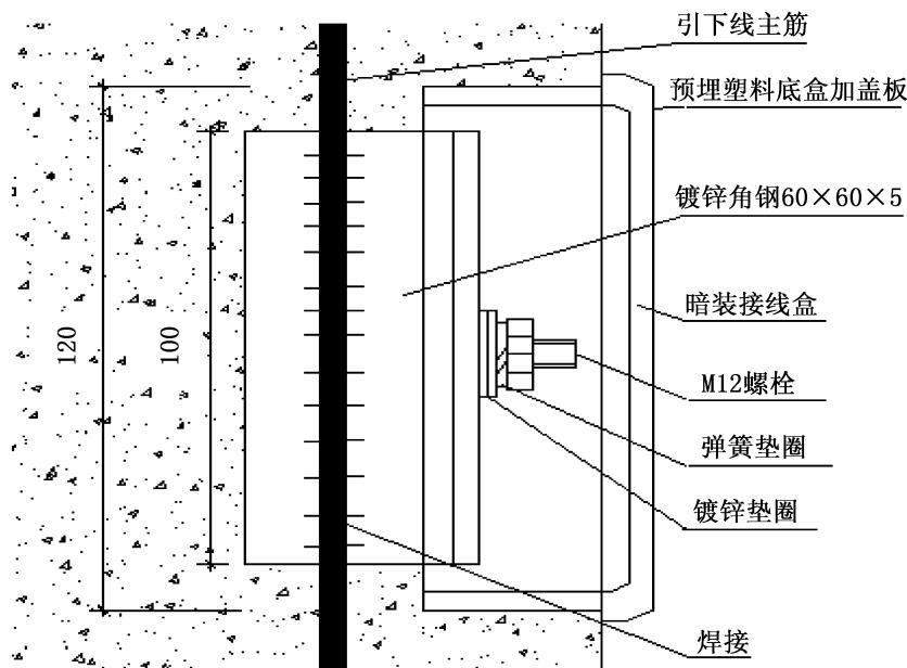
图 16 接地端子板施工大样图
