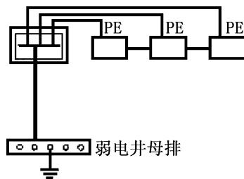
图 51 S型接地方式
