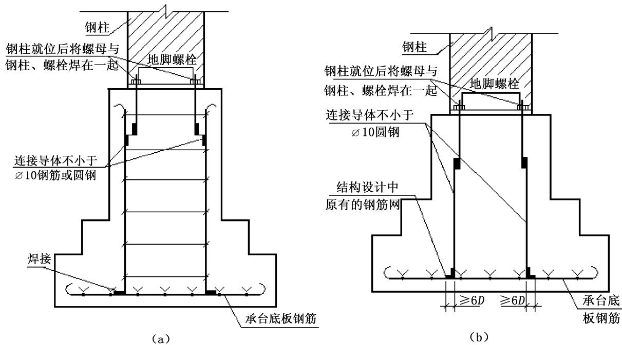
图 6 钢柱与钢筋混凝土基础的连接大样图
