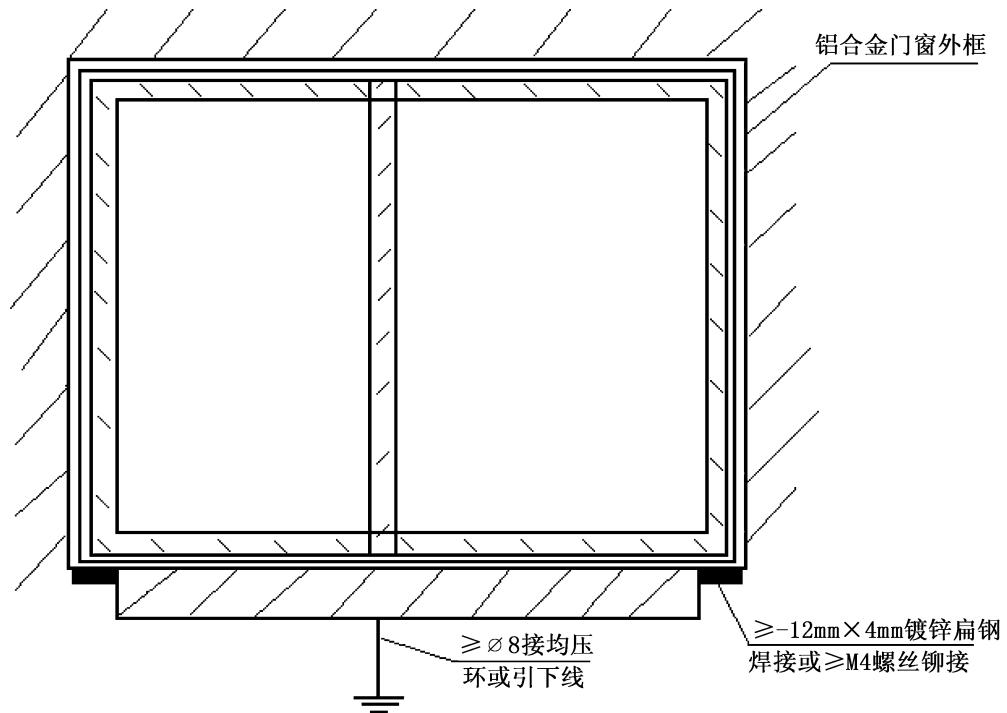
图 26 外墙金属门窗接地施工大样图
