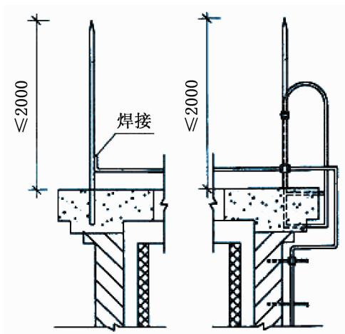
图 32 屋面避雷针施工大样图
