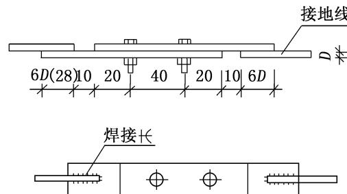
图 24 人工引下线断接卡大样图
