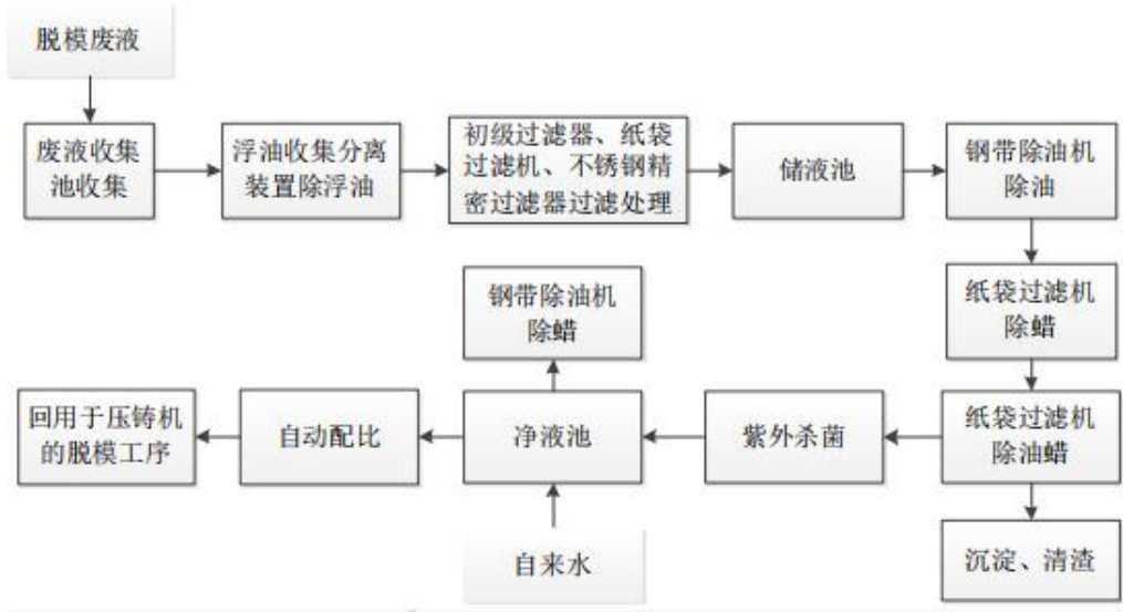
图 4-2 脱模剂回收系统工艺流程
