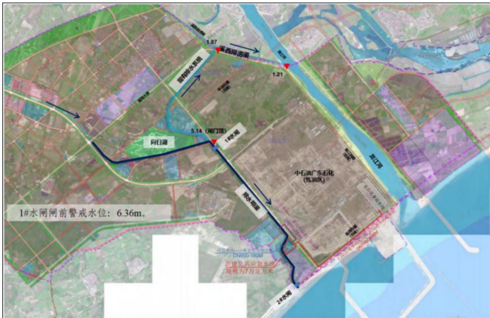
图 5.2-1 大南海石化工业园区公共应急事故水池、西排洪渠以及事故水输送管线情况图
