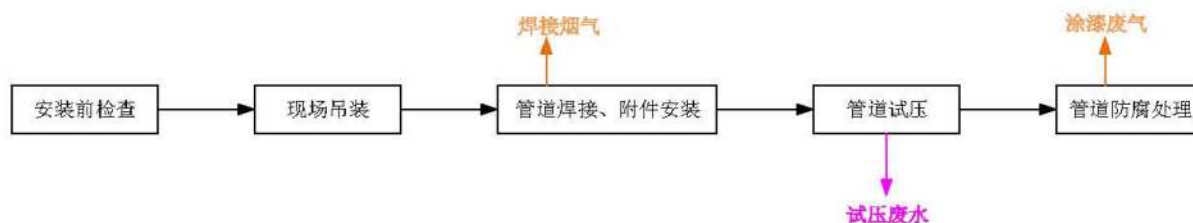
图3.6-2 二氧化碳管道安装工艺流程
