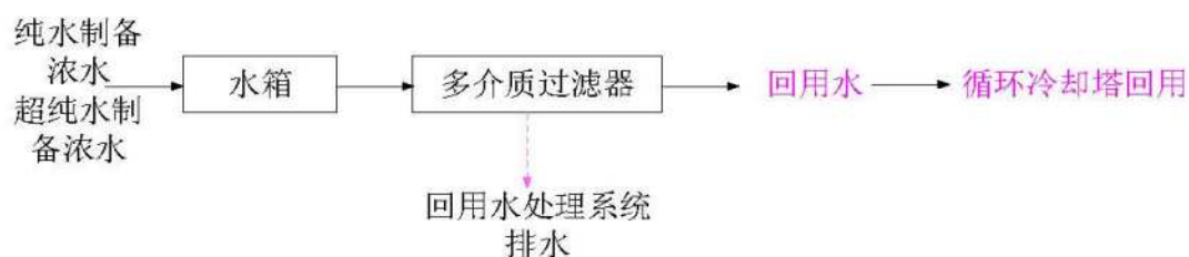
图3.5-5 回用水处理系统工艺流程示意图
