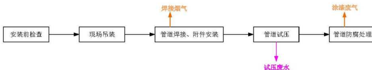
图3.2-2 二氧化碳管道安装工艺流程
