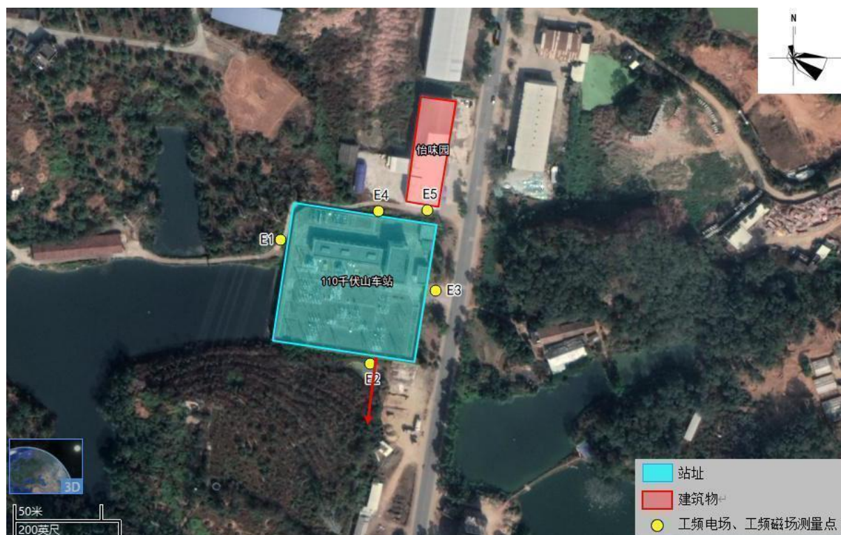
图 1 110kV 山车变电站类比监测布点图
