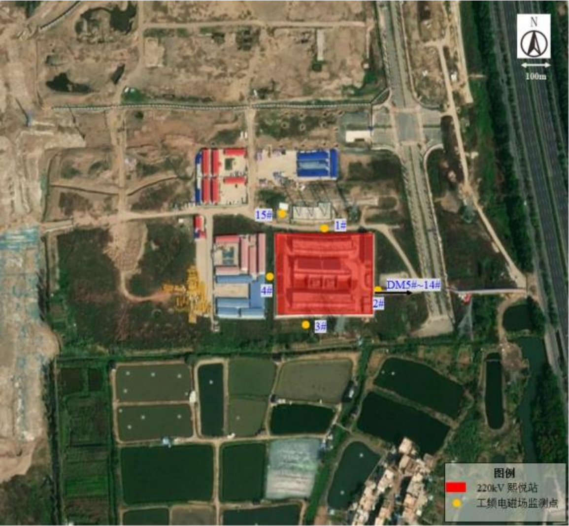
图 2 佛山 220 千伏熙悦变电站监测布点图
