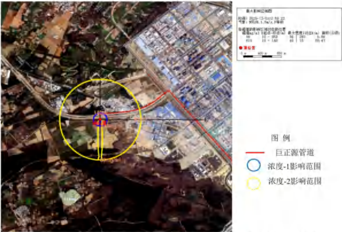
图 1.8-2 醋酸管道 10%孔径泄漏事故醋酸在下风向最大影响区域图（最不利气象条件）
