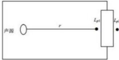
图 4.3-1 室内声源等效为室外声源图例
