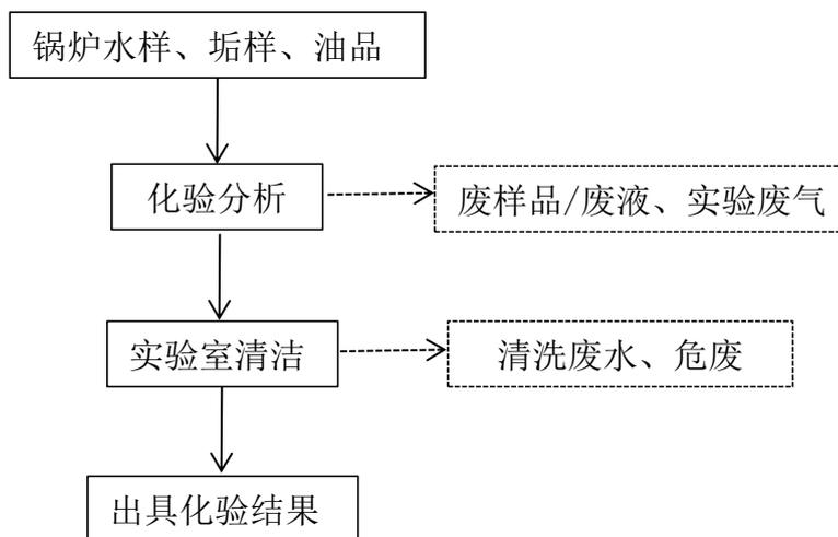
图2-2 实验室化验检测工艺流程图
