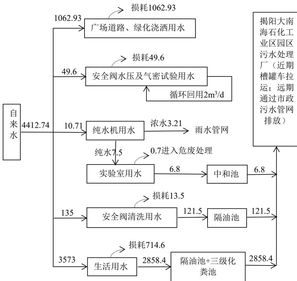
图2-1 项目水平衡图 单位：m<sup>3</sup>/a
