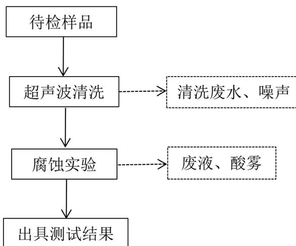
图2-3 腐蚀实验工艺流程图
