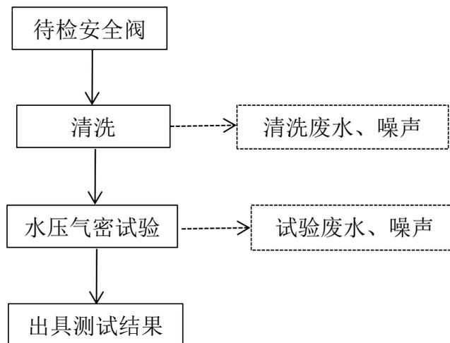
图2-4 安全阀检测工艺流程图
