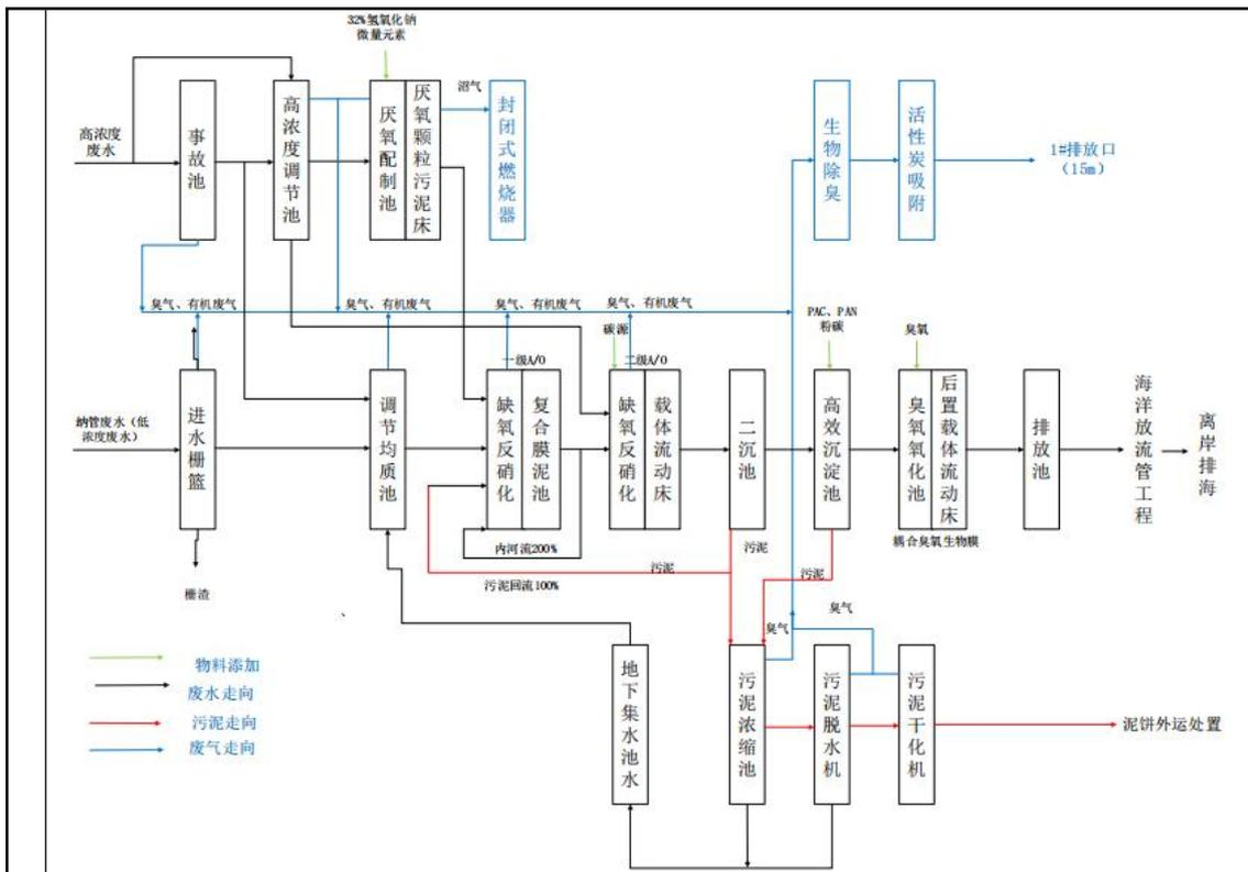
图4-1 揭阳大南海石化工业区化工污水处理项目首期工程污水处理工艺
