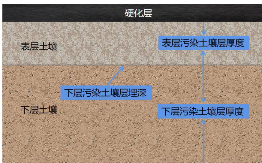
图 3-1 表层污染土壤层厚度、下层污染土壤层埋深和下层污染土壤层厚度示意图
