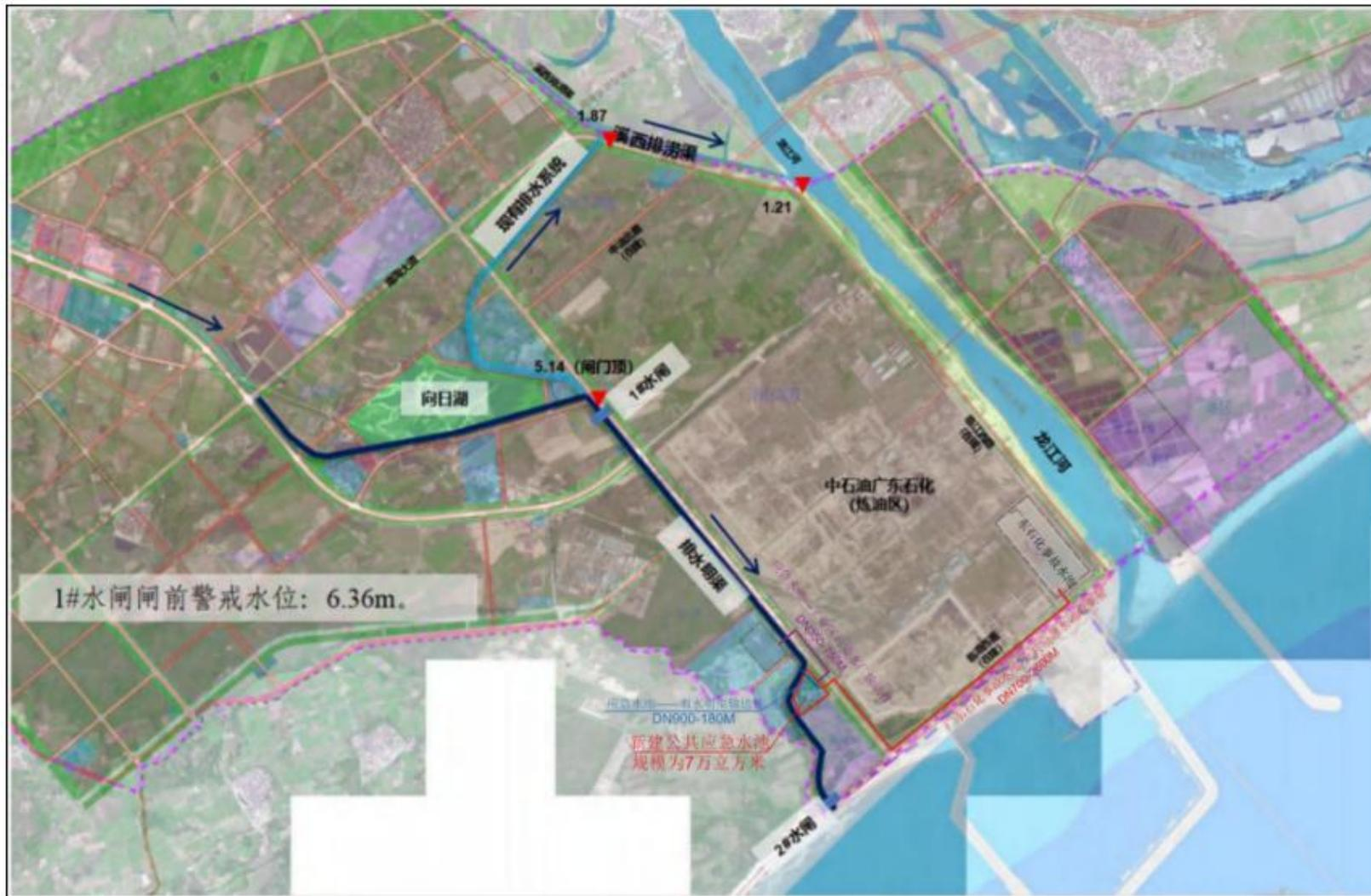
图 5.2-2 大南海石化工业园区公共应急事故水池、西排洪渠以及事故水输送管线情况图
