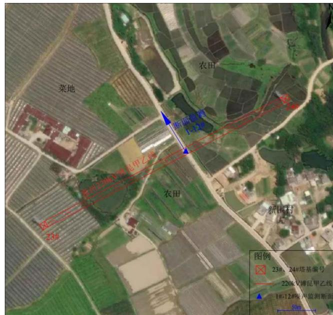
图 4.2-1 惠州 220kV 博昆甲乙线同塔双回架空线路布点示意图
