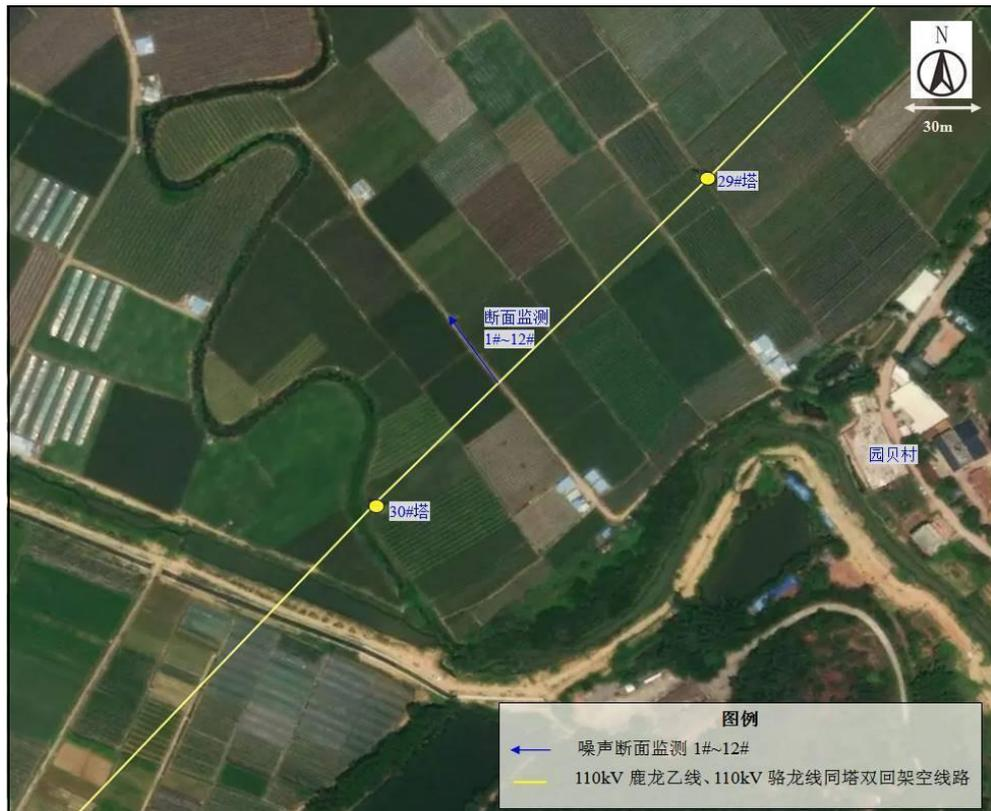
图 4.10-5 惠州 110kV 鹿龙乙线、110kV 骆龙线同塔双回架空线路监测布点图
