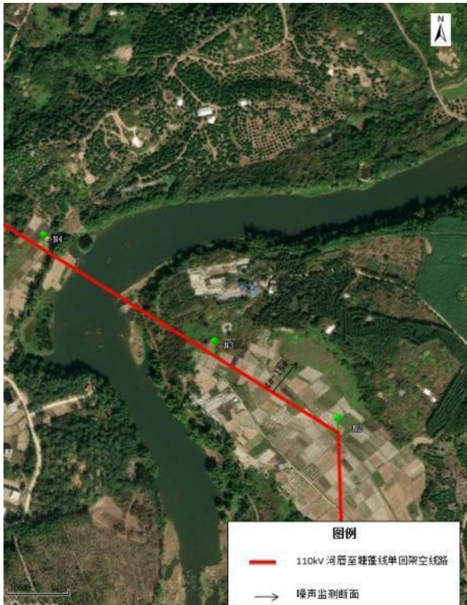
图 4.10-6 110kV 河唇至塘蓬线单回架空线路布点示意图
