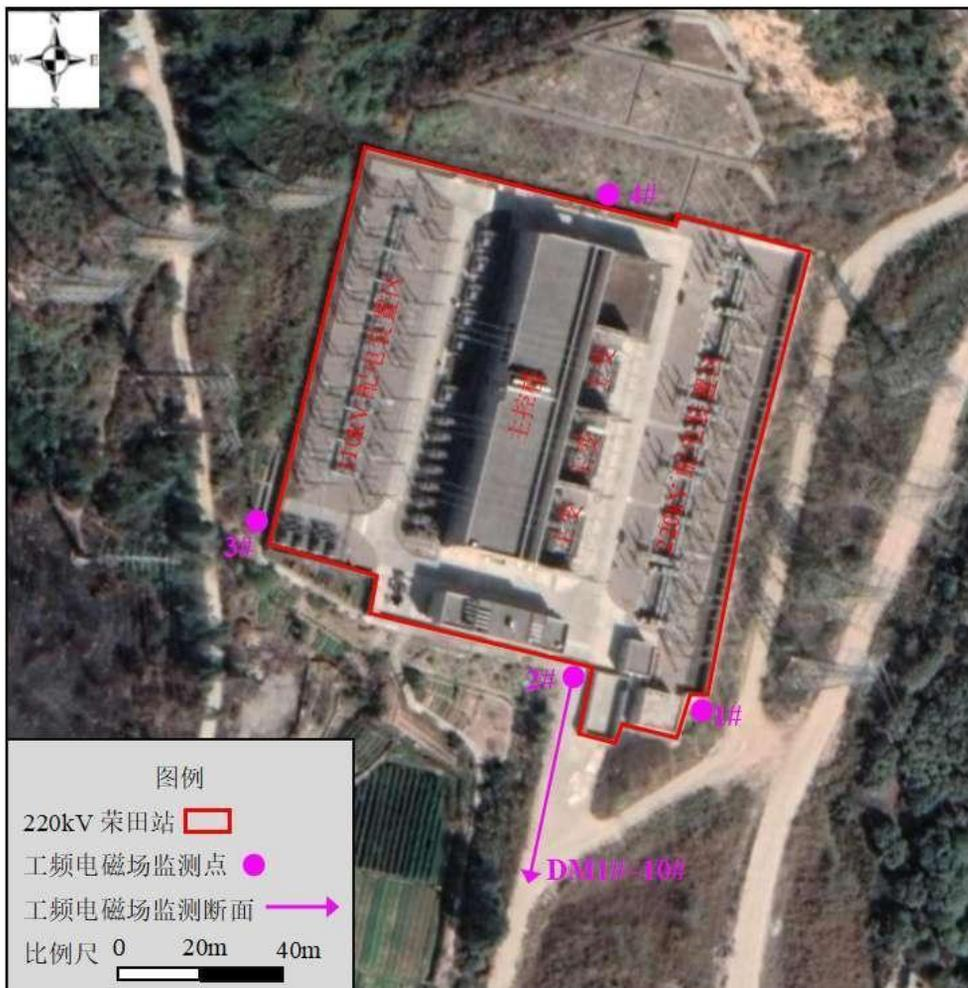
图 8.3-2 220kV 荣田变电站监测布点图
