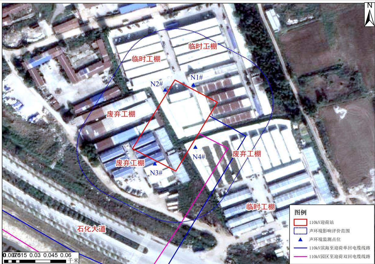
图 3-2 揭阳惠来 110 千伏迎荷（南海）输变电工程噪声现状监测布点图
