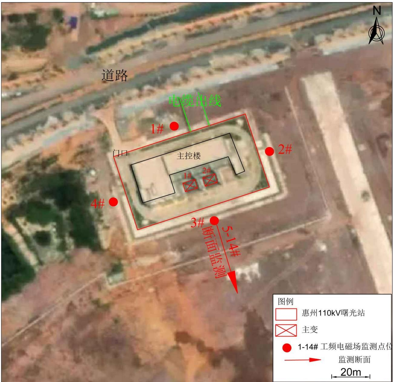
图 9.1-3 惠州 110 千伏曙光变电站监测布点图
