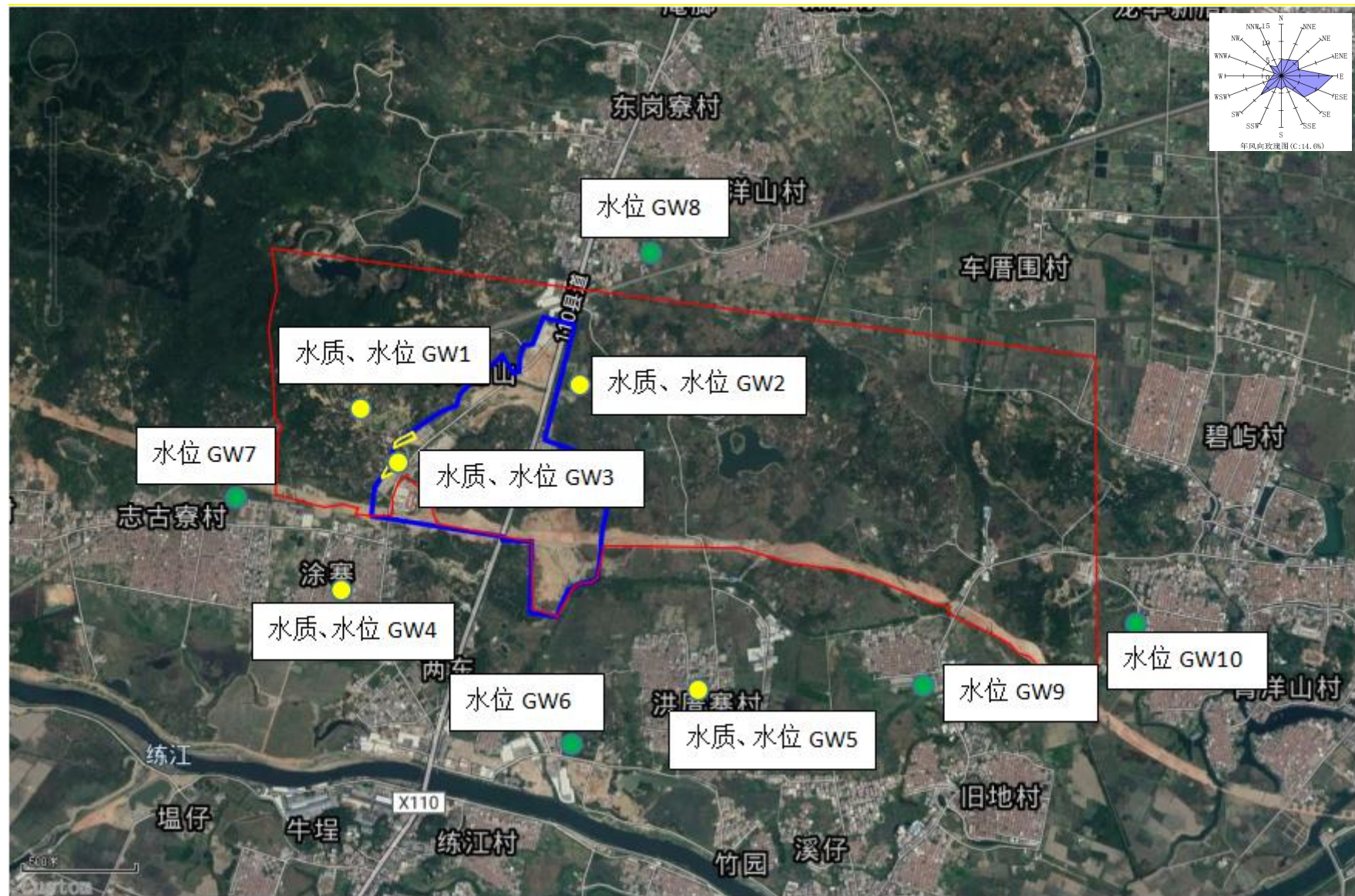
图 6.4-5 地下水现状监测布点图
