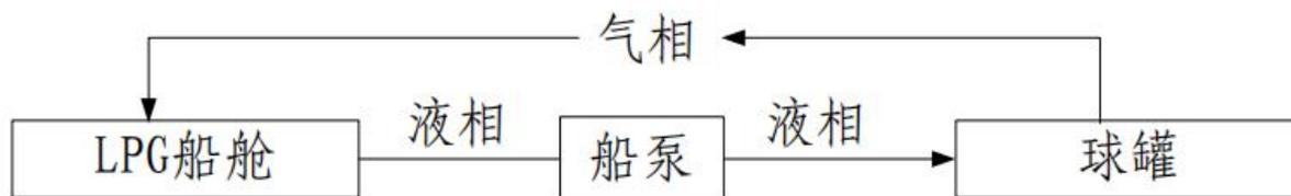
图 1.11-1 码头卸船工艺流程示意图
