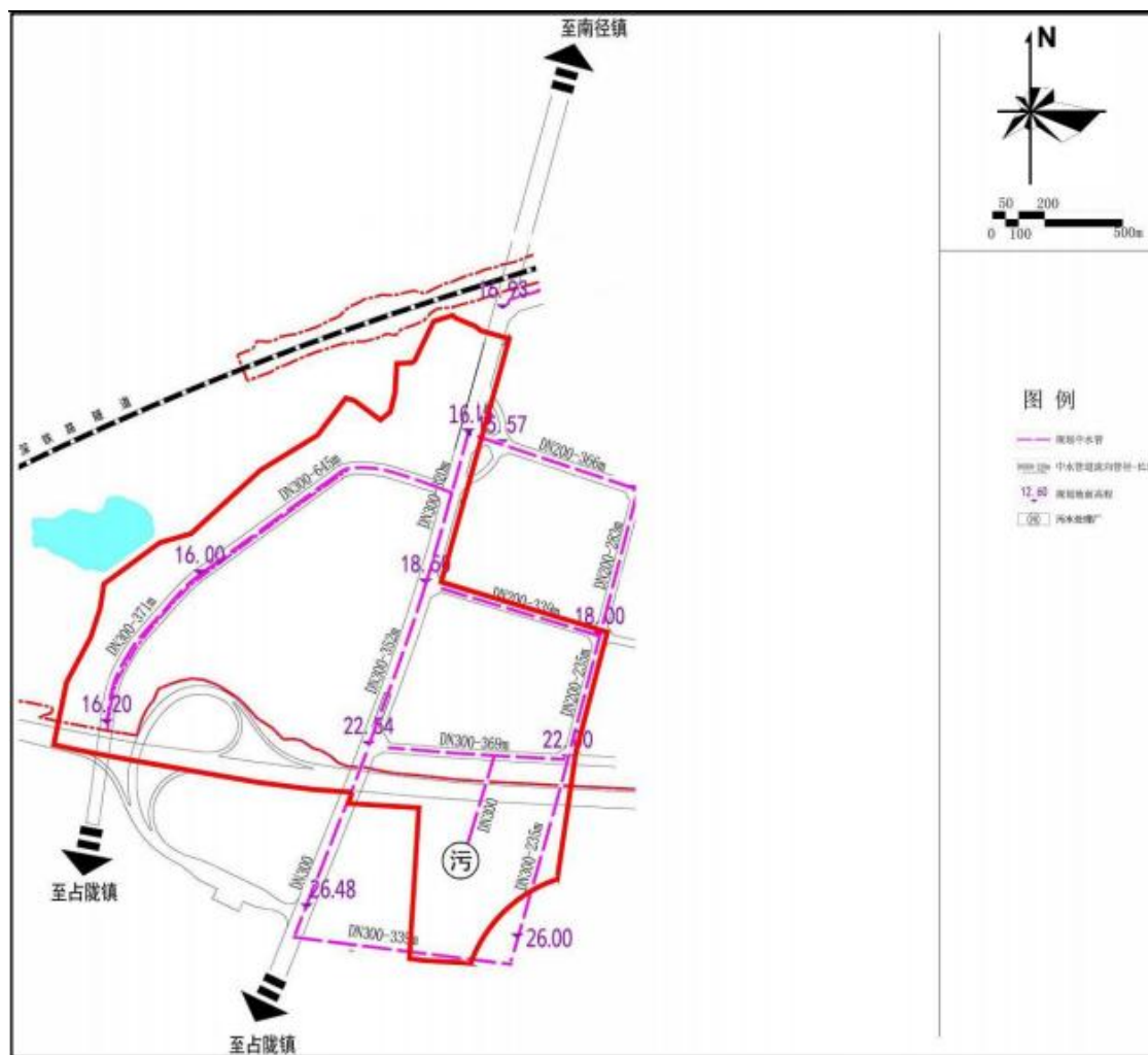
图 5.2-11 中水回用工程规划图
