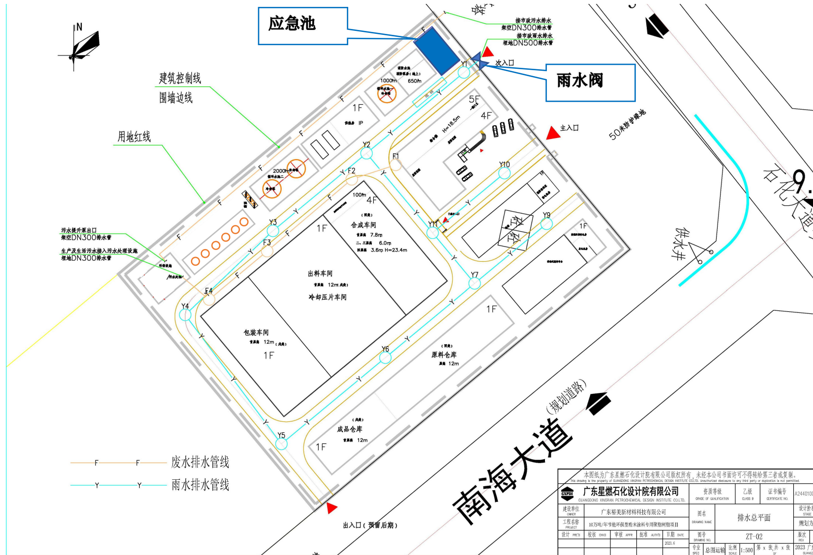
图 3.8-1 厂区雨水、污水管网图
