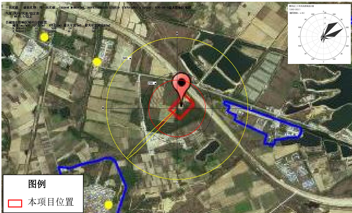
图6.9-63 乙二醇储罐泄漏发生火灾产生CO扩散最大影响范围图（最不利气象条件下）
