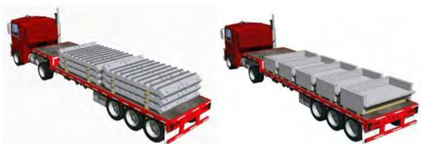
图7-5 平层叠放式运输示意图
