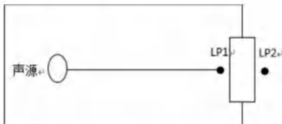
图 6.3-1 室内声源等效为室外声源图示
