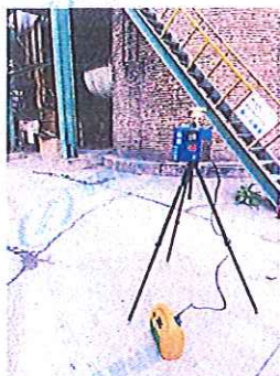
炼铁车间外无组织废气检测点
