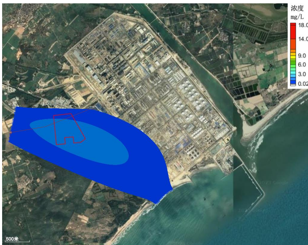
图 8.5.3-7 (e) 苯乙烯泄漏 1000d 后地下水环境中苯乙烯浓度污染晕示意图
