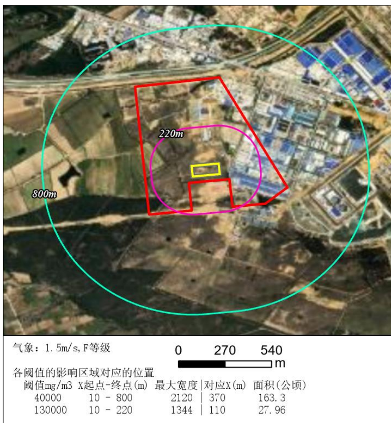
图 8.5.1-6 (a) 储罐全破裂时, 异丁烷储罐泄漏事故最大影响范围图 (最不利气象条件下)
