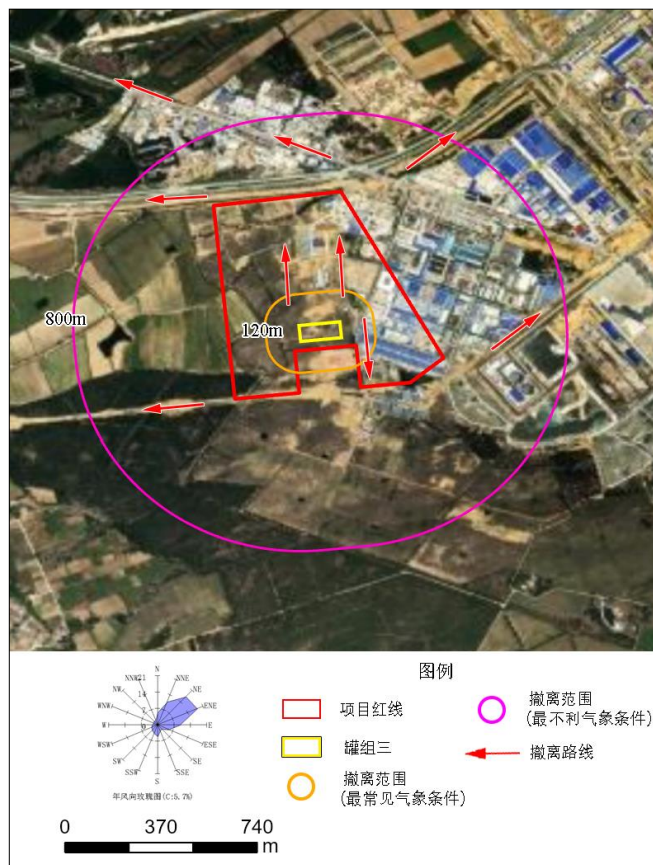
图 8.6-3 (c) 应急疏散范围及撤离路线图 (异丁烷储罐全破裂泄漏)
