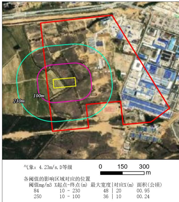
图 8.5.1-2 (b) 最常见气象条件下, 乙腈储罐泄漏事故最大影响范围图
