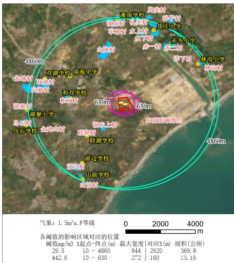
图 8.5.1-8 (a) 脱重塔塔顶出料管泄漏时，双环戊二烯储罐泄漏事故最大影响范围图（最不利气象条件下）
