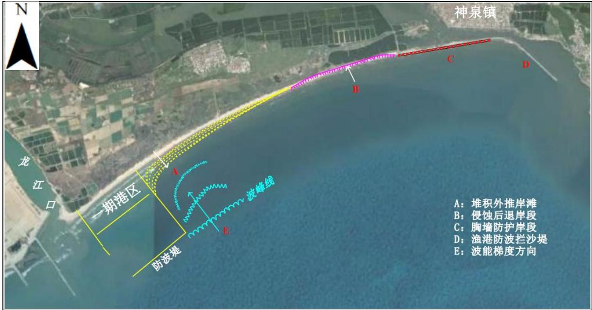
图 4.3.3-2 防波堤工程后上波侧岸滩长期演变示意图
