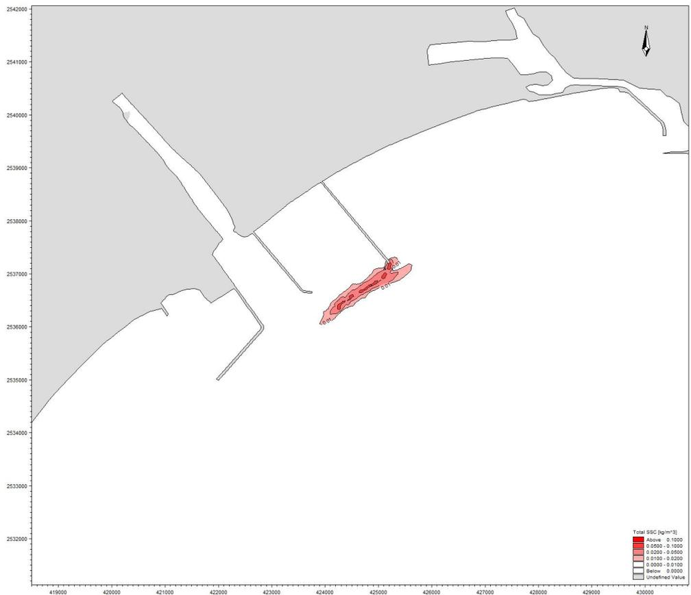
图 4.3.4-2 东防波堤中与海岸平行段抛石施工产生悬沙增量最大包络线图
