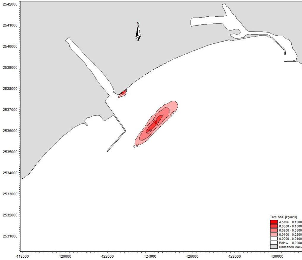
图 4.3.4-6 典型工况一（挖泥+溢流）施工悬沙扩散包络线图
