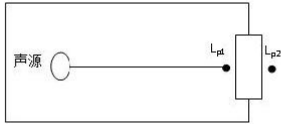
图 4-1 室内声源等效为室外声源图例
