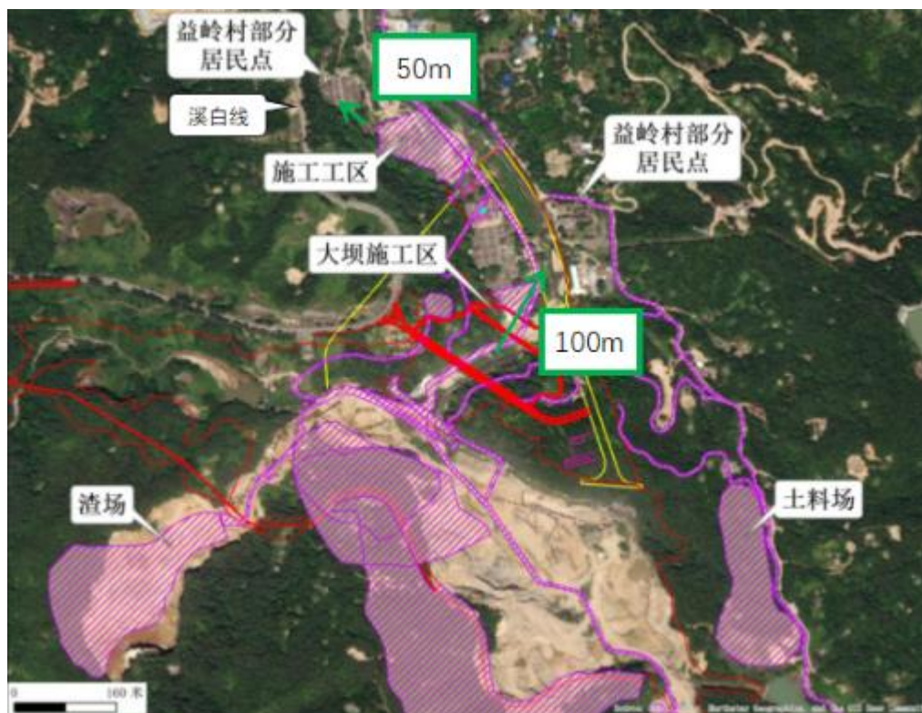
图 5.5.1-2 大坝枢纽区主要噪声源与周边居民点分布及空间位置关系示意图
