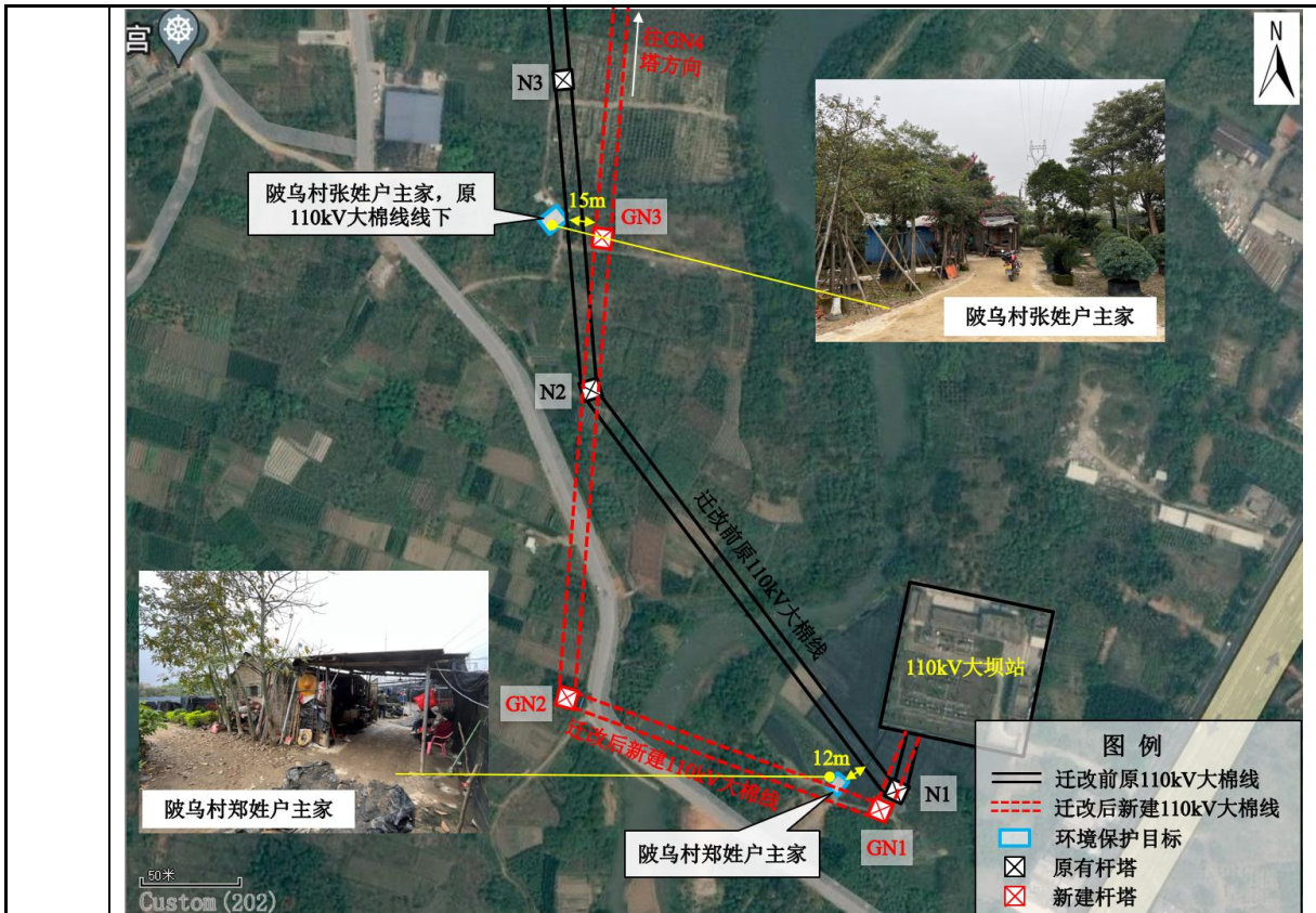
图 4 本工程架空线路迁改前线路周围的环境保护目标（陂乌村郑姓户主家、陂乌村张姓户主家）
