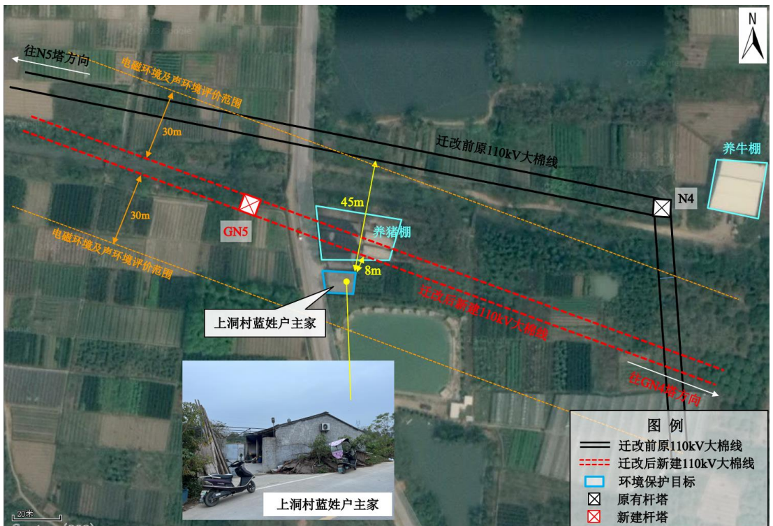
图 19 本工程迁改前后线路周围环境保护目标（上洞村蓝姓户主家）
