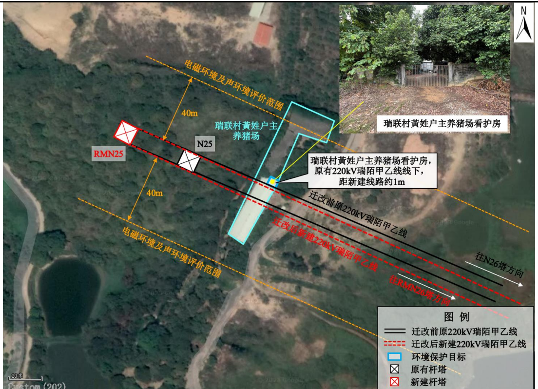
图 16 本工程迁改前后线路周围的环境保护目标（瑞联村黄姓户主养猪场看护房）
