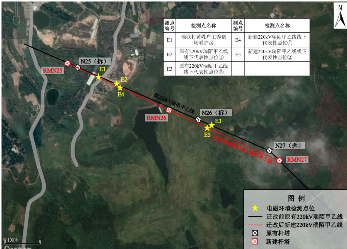
图 1 - 1 本工程电磁环境现状监测布点图-220kV 瑞陌甲乙线 N25-N27 塔段迁改工程
