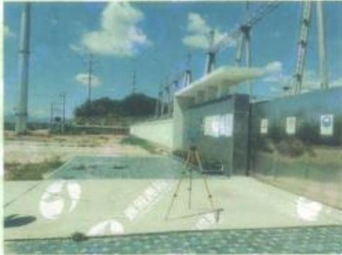
变电站东侧电磁场监测
