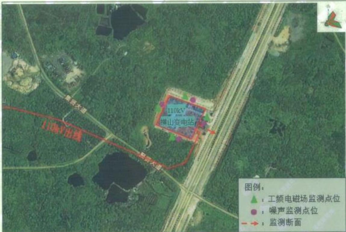
图1 横山变电站监测布点图
