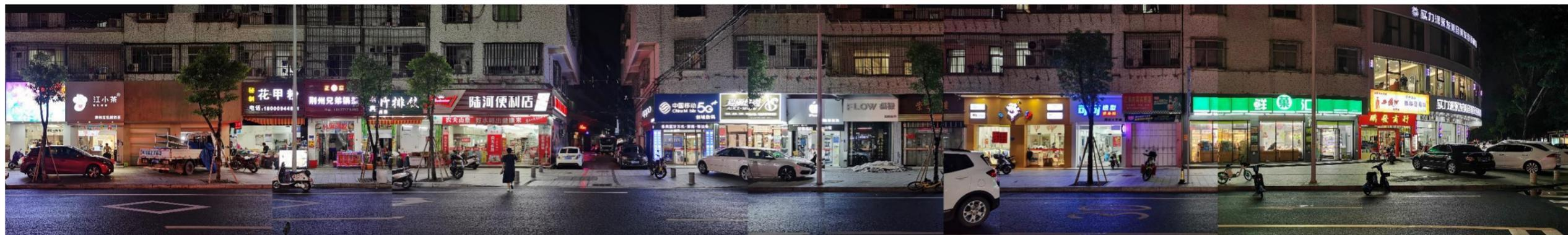
**(3) 弘德路：**①亮度：总体的亮度较高，但整个路段的亮化程度不高，照明均匀度低；灯光色彩杂乱不一，某些广告的色彩强烈；②照明方法：照明方法多样，包括投光灯、霓虹灯、灯箱、显示屏等照明方式；③与环境的协调情况：该路段的户外广告亮化色彩鲜艳、形式多样，一定程度上强化了该路段的商业气息，但总体的协调性低；④照明灯具、支架：不少自设的投光灯灯具和支架老旧，可能存在安全隐患。
