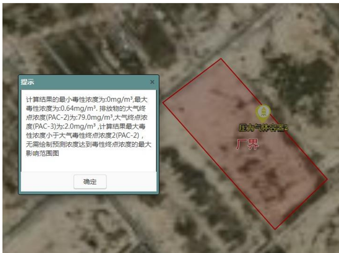
图 1-5 船燃油储罐 SO 2 风险预测结果
