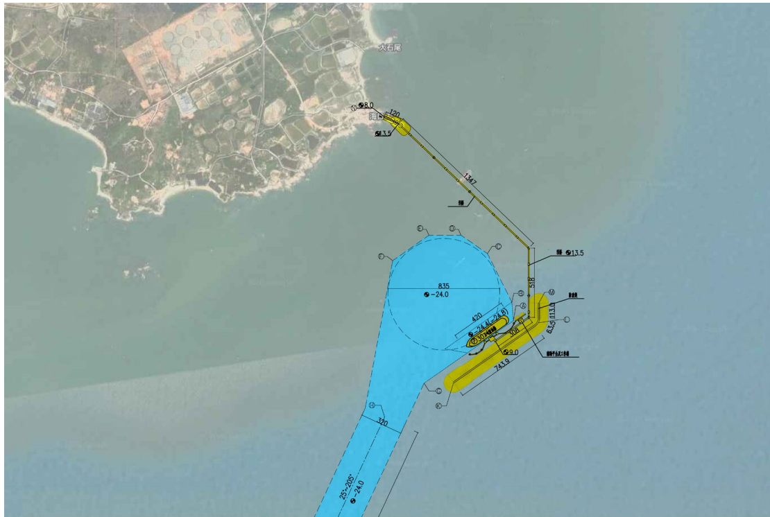
图2 资深作业区在建30万吨油码头总平面布置图
