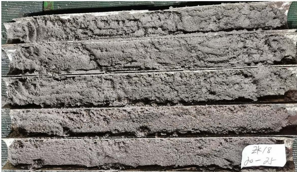
图 6.2.2-4 陆丰组海相砾质砂层（ZK99 进尺 20-25m）
