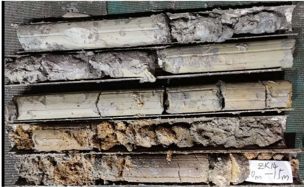
图 6.2.2-2 澄海组浅海相砾质泥质砂层 (ZK14 进尺 13.0-15.0 m)
