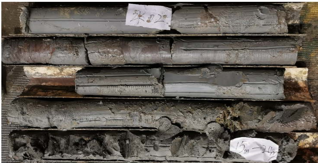
图 6.2.2-3 潮州组海相粉质粘土层 (ZK02 进尺 15.0-18.0m)
