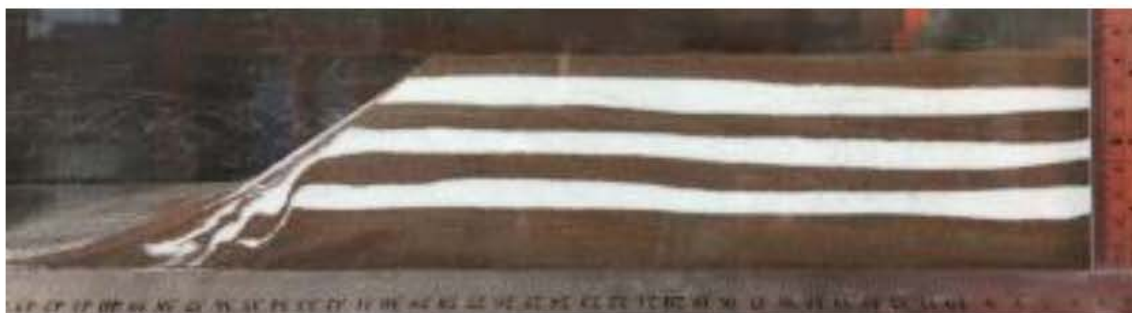
图 7.3.6-2a 采砂深度 8cm 实验照片
