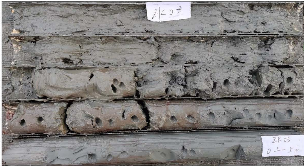
图 6.2.2-1 东里组粉质粘土沉积层 (ZK03 进尺 3.0-5.0m)
